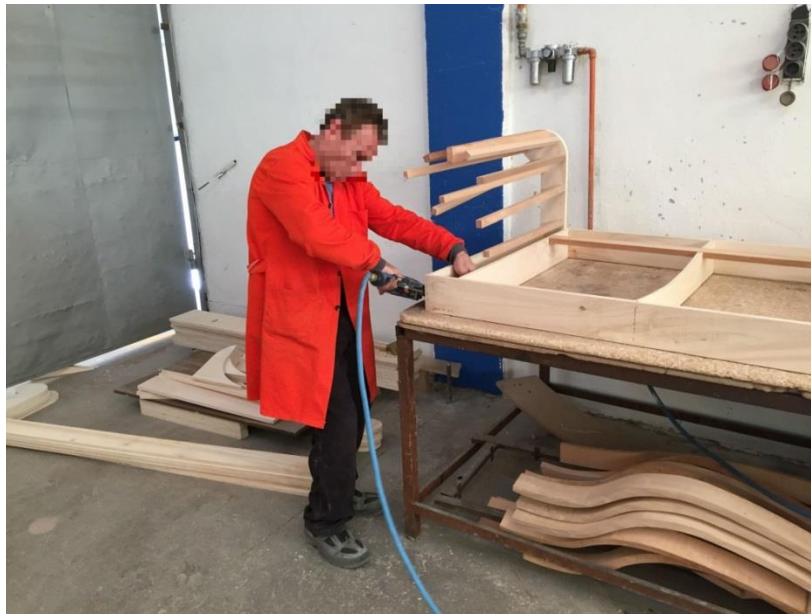
Resim 4.44. İnce çıtaların şerit vidalama tabancası ile birleştirilmesi görevi
