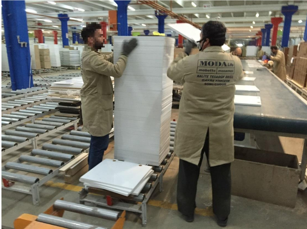
Resim 4.32. Silimden gelen parçaların paketleme alanına gitmeden önce istiflenmesi görevi
