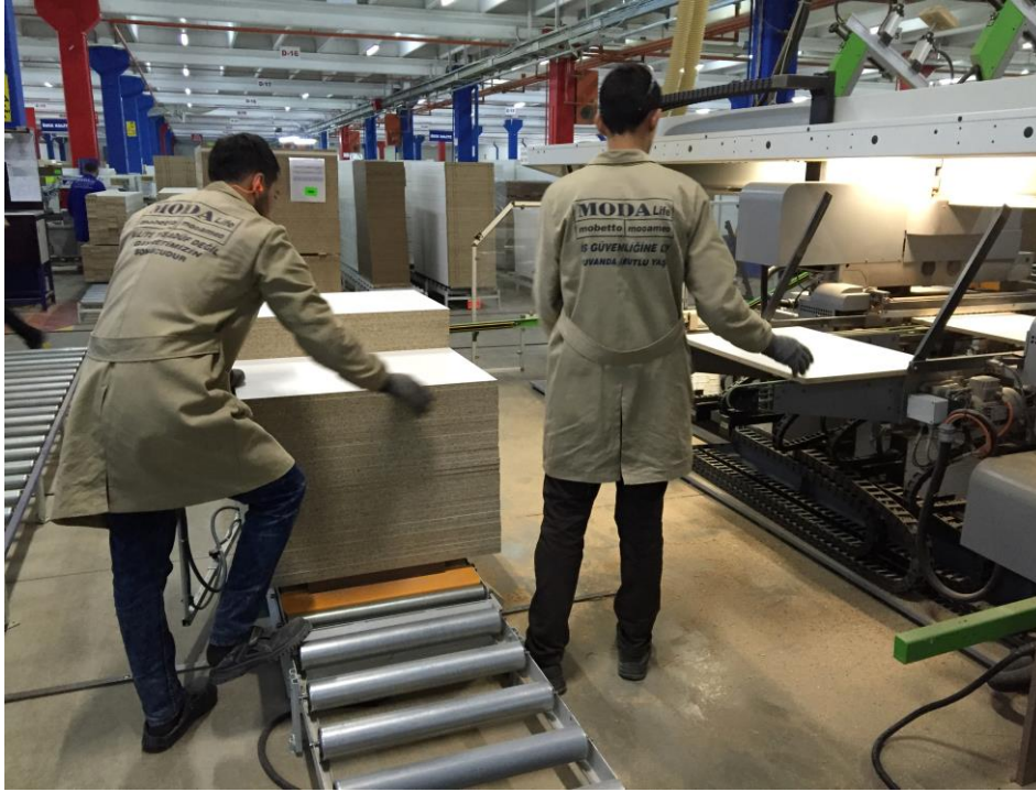
Resim 4.27. Delik makinesinden çıkan parçaların istiflenmesi görevi
