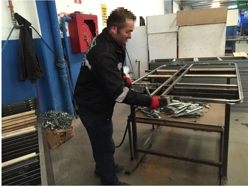
Resim 4.42. Kanepe metallерinin montajla birleştirilerek koltuğun iskeletinin oluşturulması görevi
