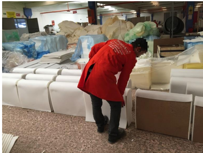
Resim 4.49. Koltuk/ kanepenin kollarına süngerleme işleminin yapılması görevi
