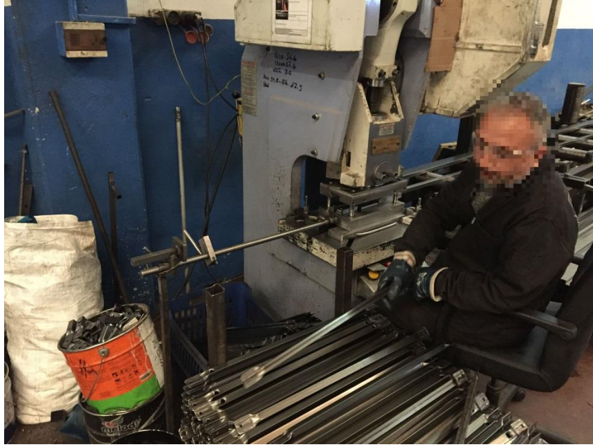
Resim 4.39. Montajı yapılacak metal parçaların preslenmesi görevi
