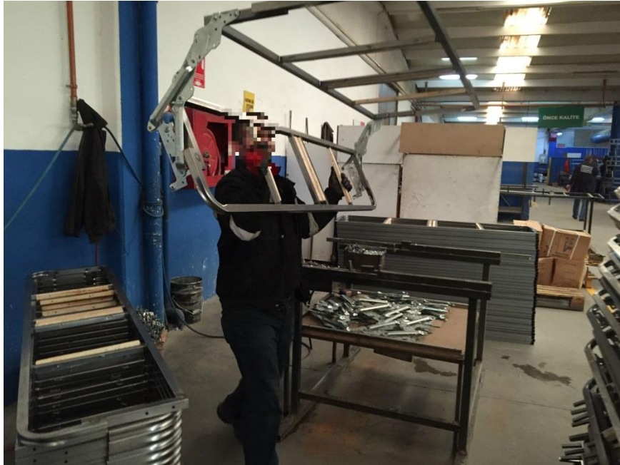
Resim 4.43. Metal parçaların birleştirilmesi ile oluşan koltuk iskeletinin istiflenmesi görevi
