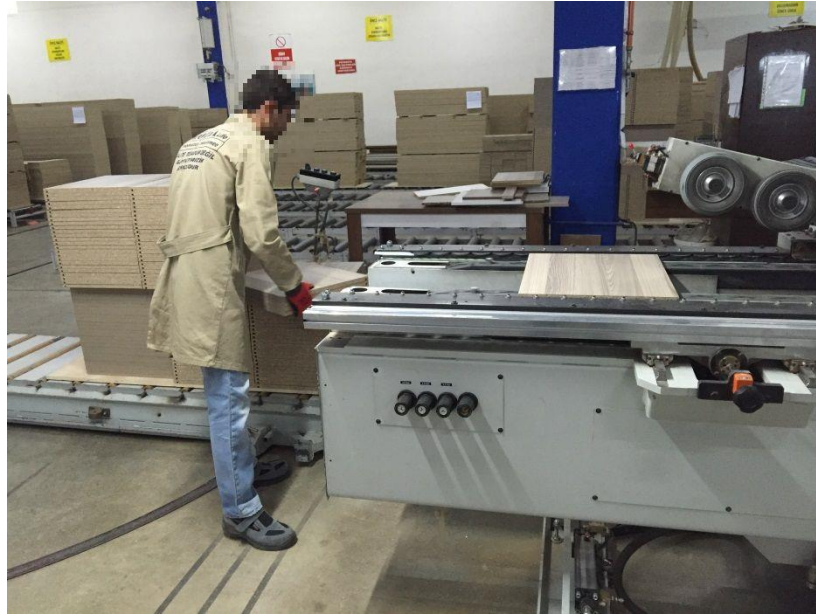
Resim 4.24. Ebatlama bölümünden gelen parçaların bantlama işlemine sokulması görevi
