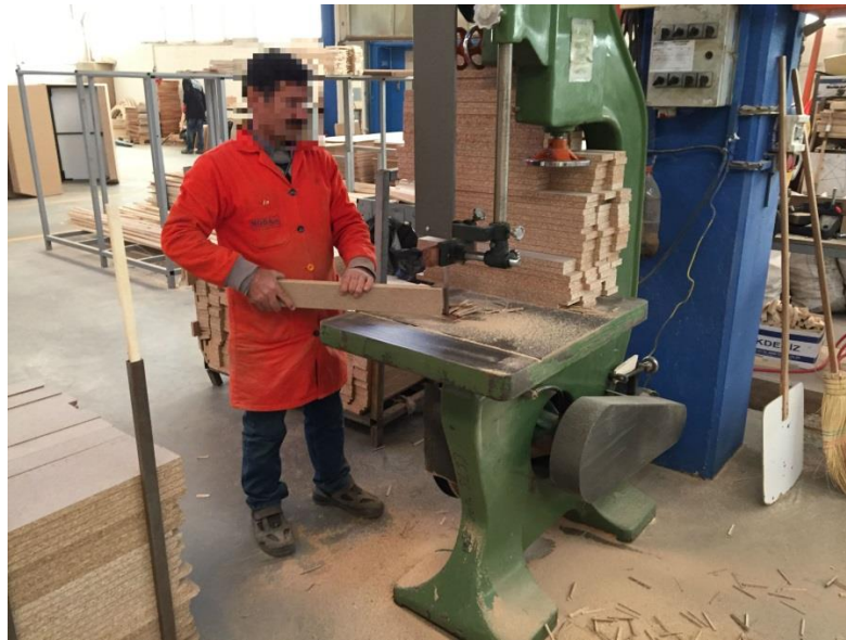
Resim 4.46. Şerit testere makinesinde çıtaların küçük parçalara ayrılması görevi
