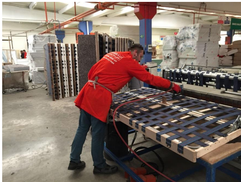
Resim 4.50. Elastik kolon makinesinde elastikleme işleminin yapılması görevi
