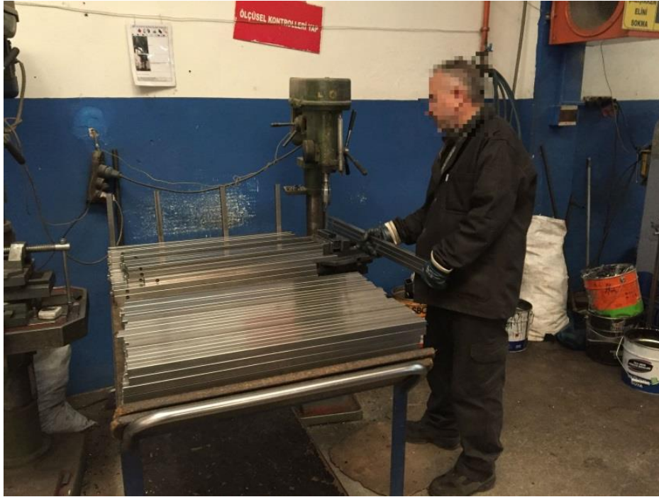
Resim 4.40. Metal parçaların montaja hazırlanması için makinede delinmesi görevi
