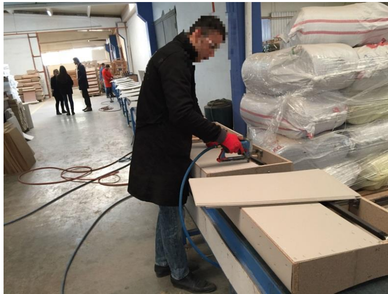
Resim 4.48. Metal parçalar ve ahşap parçaların birleştirilerek kanepenin kolunun oluşturulması görevi
