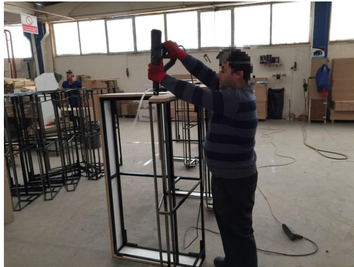
Resim 4.45. Koltuk iskeletlerine çivileme tabancası ile çıtaların monte edilmesi görevi
