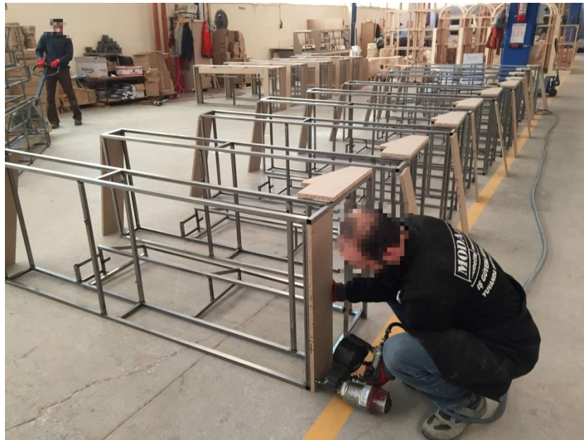
Resim 4.47. Koltuk iskeletine havalı tabanca ile çıtalarn çivilenmesi görevi
