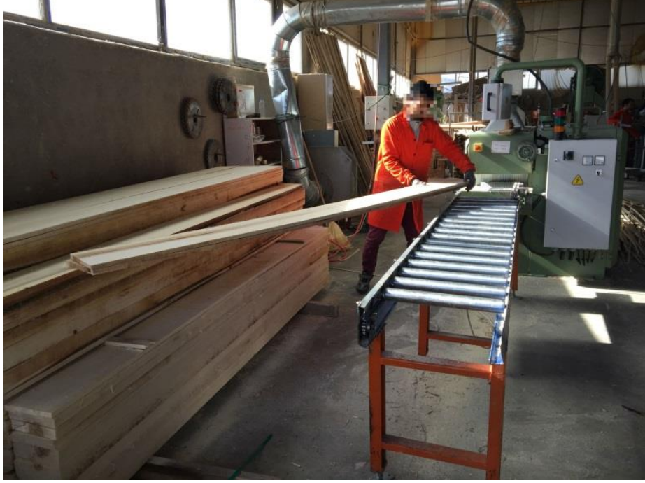
Resim 4.60. Malzemelerin boyuna kesilmek üzere çoklu dilim makinesine konulması görevi
