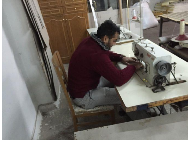
Resim 4.11. Döşenecek kumaşın dikilmesi işlemi (4.işyeri)
