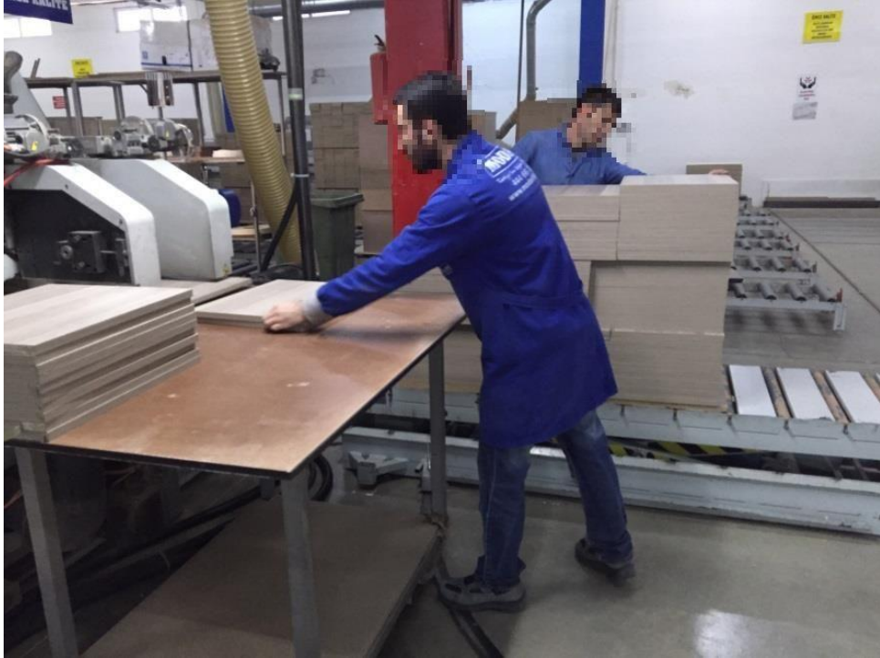
Resim 4.25. Bantlama işleminden çıkan parçaların istiflenmesi görevi
