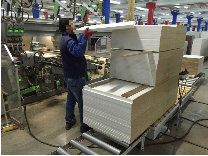
Resim 4.26. İstiflenmiş parçaların delik makinesine yerleştirilmesi görevi
