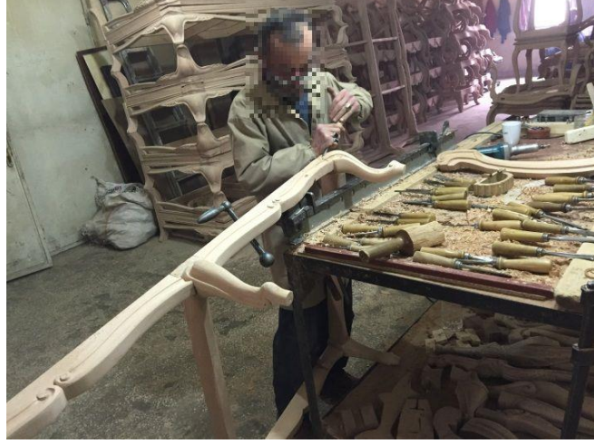
Resim 4.19. Parçaya oyma işleminin yapılması (6.işyeri)
