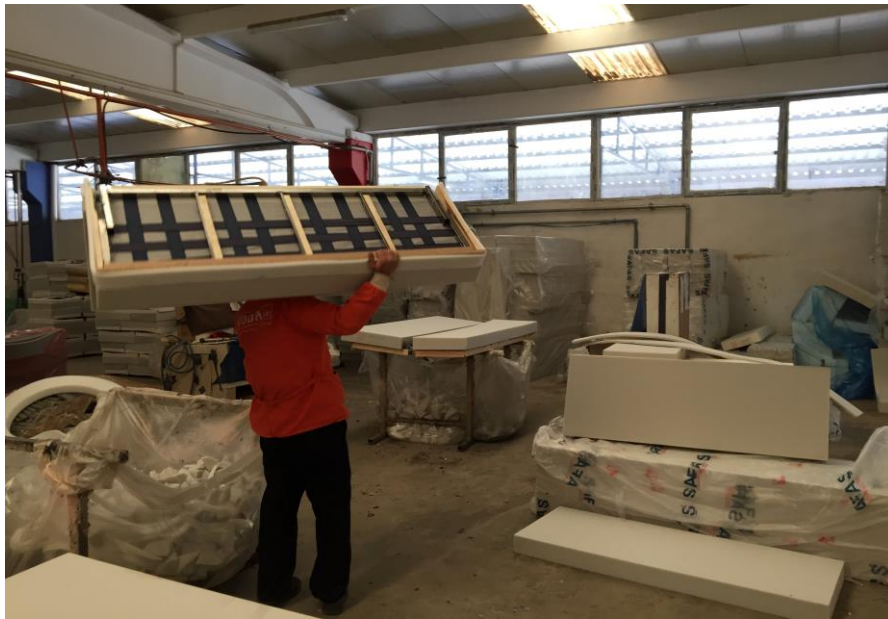
Resim 4.51. Astarlama ve beyazlama işlemi biten iskeletin istiflenmesi görevi
