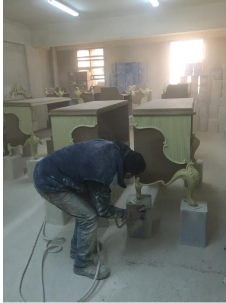
Resim 4.14. Malzemeye boya ile dolgu işlemi yapılması (5.işyeri)
