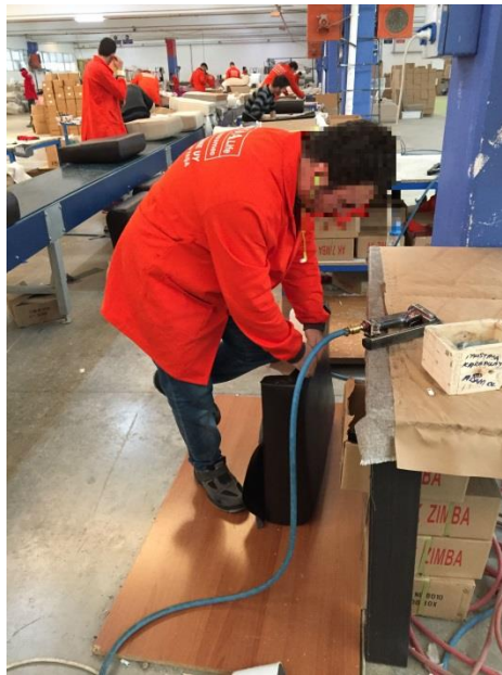
Resim 4.57. Koltuk/ kanepeler koluna deri malzemenin giydirilmesi görevi
