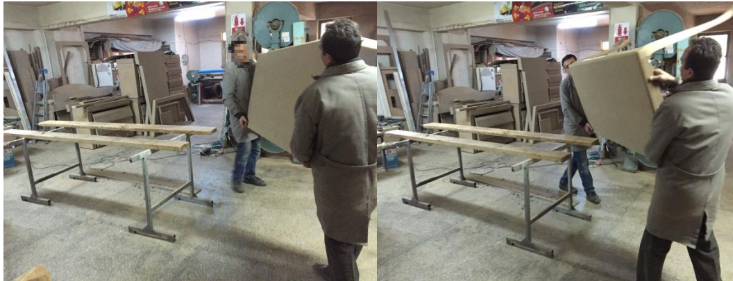
Resim 4.8. Parçaların platforma konulması ve platformdan alınması işlemi (3.işyeri)
