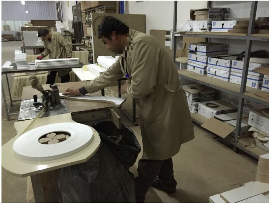
Resim 4.36. Bantlama işlemi makinede yapılamayan parçanın eğri kısımlarının çalışan tarafından elle yapılması görevi
