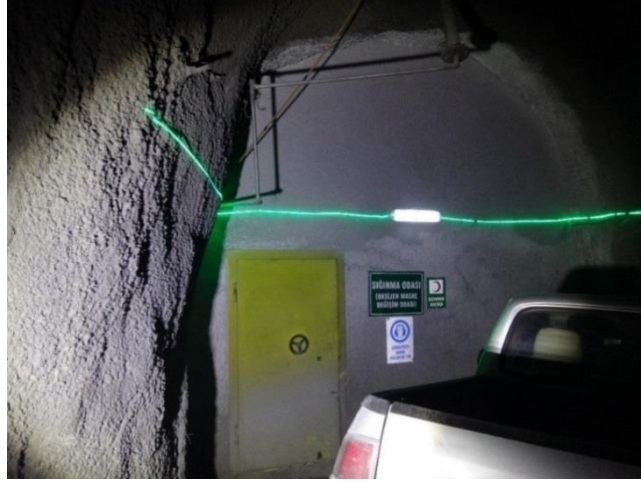
Şekil 4.15. İşletmede bulunan sabit sığınma odasının dışarıdan görünüşü
