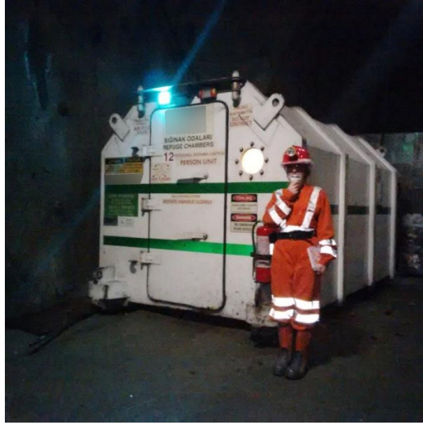
Şekil 4.9. Maden No.2’de bulunan taşınabilir sığınma odası
