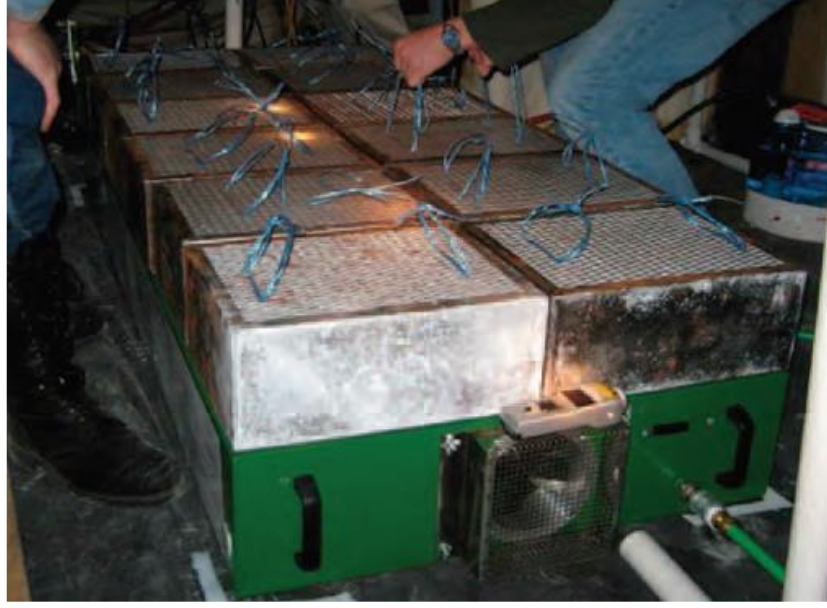
Şekil 2.3. CO 2 temizleyicisi olarak kullanılan sodalı kireçlerin bulunduğu kartuşlar [20]
