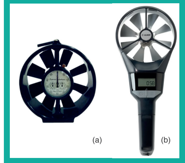
Şekil 5.1. Anemometre türleri (a) mekanik (Carroll Technologies Group, 2022) ve (b) dijital (Alnor, 2022)
