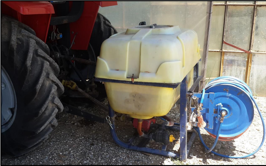
Resim 4.13. Kuyruk mili muhafazası sökülmüş pülverizatör
