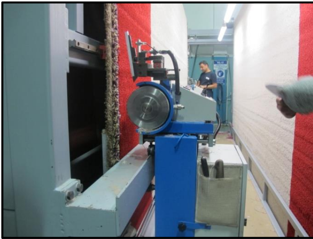
Resim 4.27. Halı boyuna kesim makinesi ve silindir bıçak
