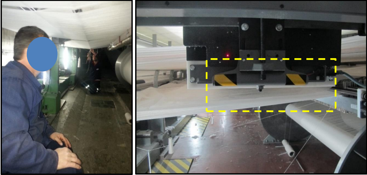
Resim 4.15. Dokuma makinesinde kopuş bağlama ve uyarıcı işaretler
