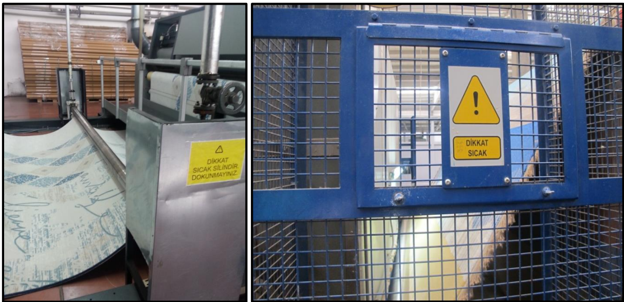
Resim 4.23. Korumasız ve korumalı apre silindirleri
