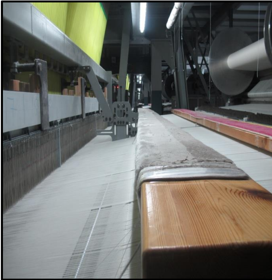
Resim 4.16. Dokuma makinesinde çözümlü iplikleri üzerinde kopuş bağlama
