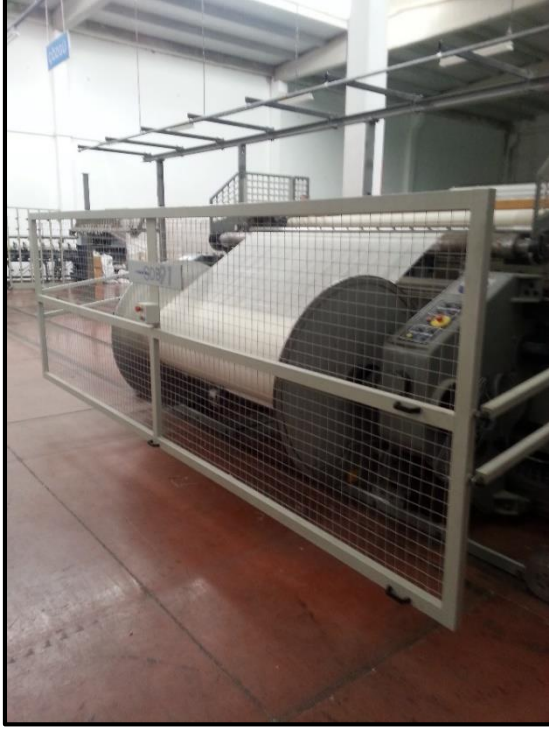
Resim 4.8. Koruması bulunan ve bulunmayan çözümlü hazırlama makinesi
