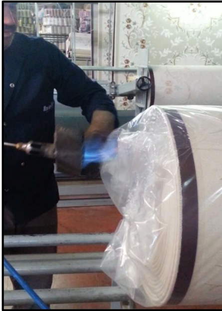
Resim 4.33. Shrinkleme işlemi için kullanılan pürmüz ve kapalı shrink makinesi
