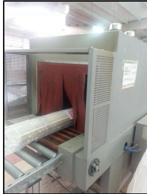
Resim 4.33. Shrinkleme işlemi için kullanılan pürmüz ve kapalı shrink makinesi
