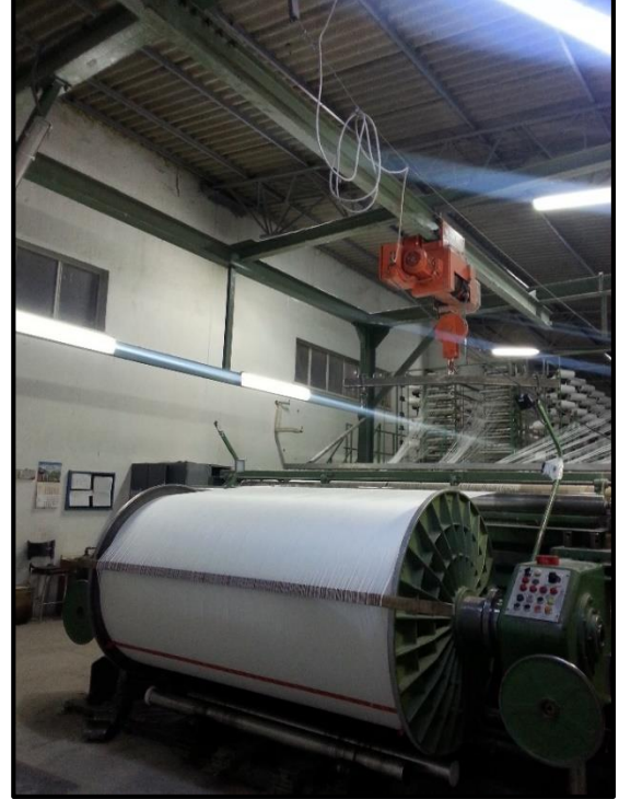
Resim 4.8. Koruması bulunan ve bulunmayan çözümlü hazırlama makinesi
