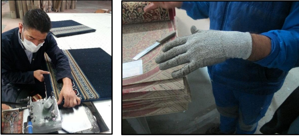
Resim 4.31. Halı kenar overlock işlemi ve hataların giderilmesinde KKD kullanımı
