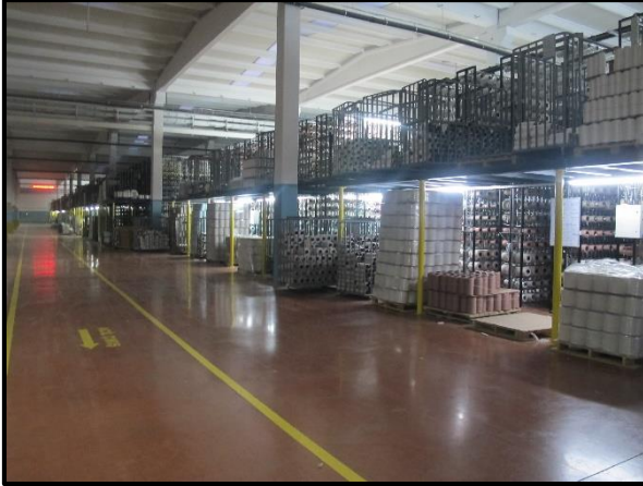
Resim 4.5. Korkuluk bulunmayan cağlık sistemleri
