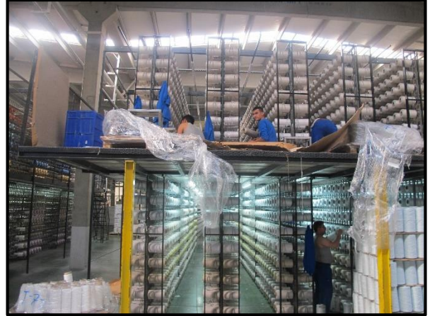
Resim 4.5. Korkuluk bulunmayan cağlık sistemleri
