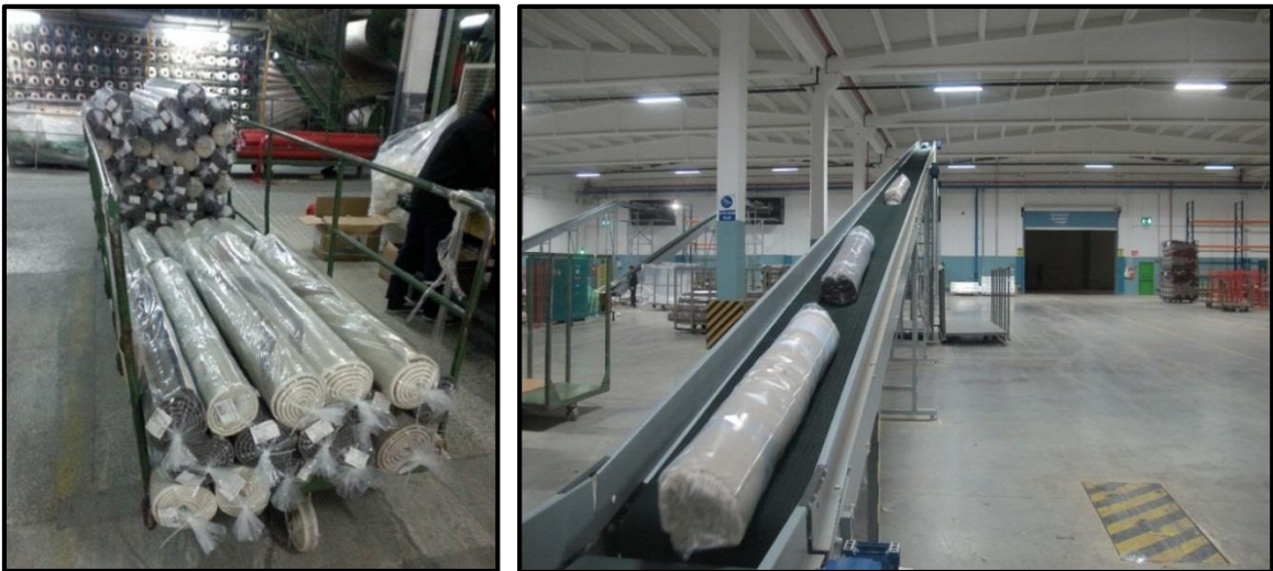
Resim 4.37. Halı rulolarının halı arabası ya da konveyörle sevk edilmesi
