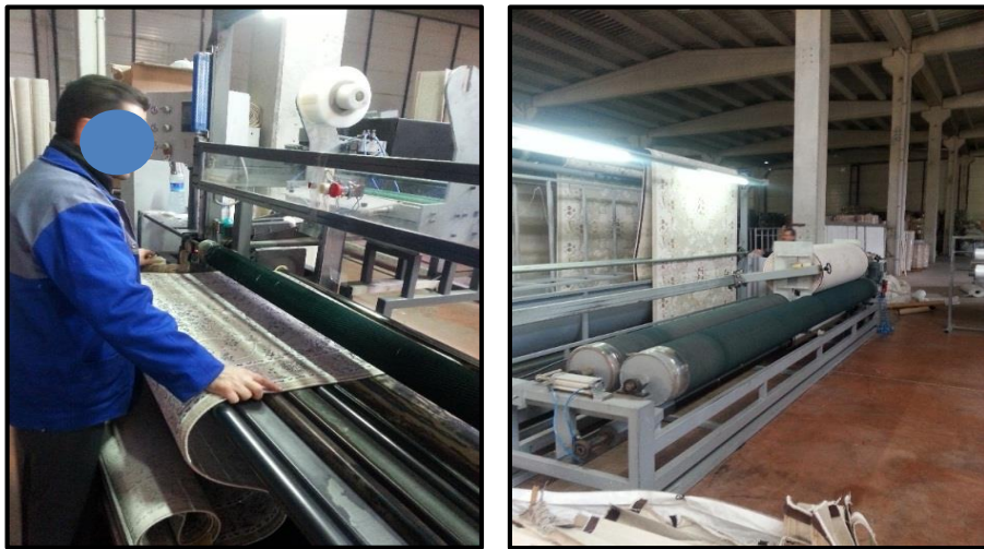
Resim 4.32. Halı büküm işlemi ve açıkta dönen silindirler
