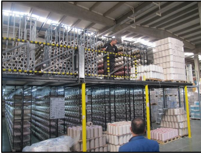
Resim 4.6. Korkuluk bulunan çağlık sistemleri
