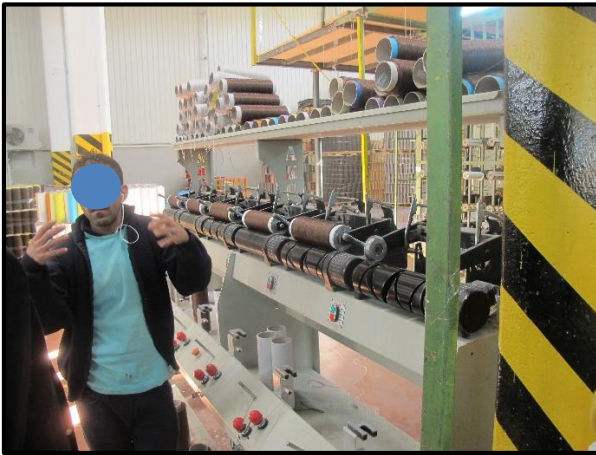
Resim 4.9. Çözgü aktarma makinesi ve ring iplik kesme bıçağı
