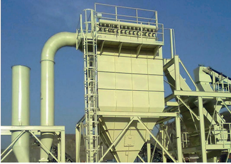
Resim 5. Hava geçirgen torbalarda toz zıplama ve üretime geri kazandırma sistemi
