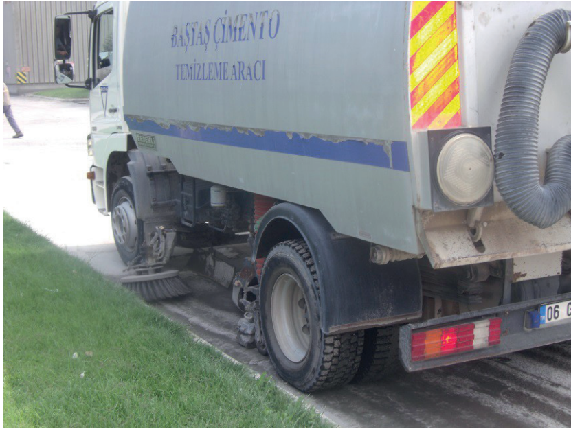
Resim 10. Araç geçişlerinin olduğu yollarda biriken tozu vakum yaparak ve filtreleyerek kendi deposuna çeken süpürge aracı
