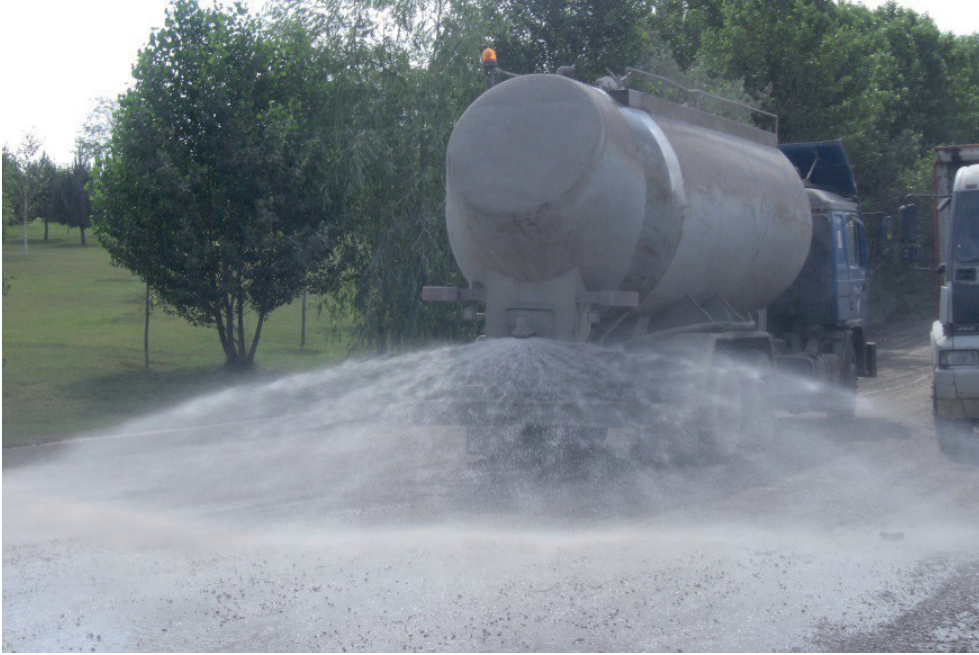
Resim 3. Nakliye yollarında (dahili ve ocak-fabrika olası) rüzgar ve trafik sebebi ile tozun havaya karışmasını engelleyen su püskürtme sistemi
