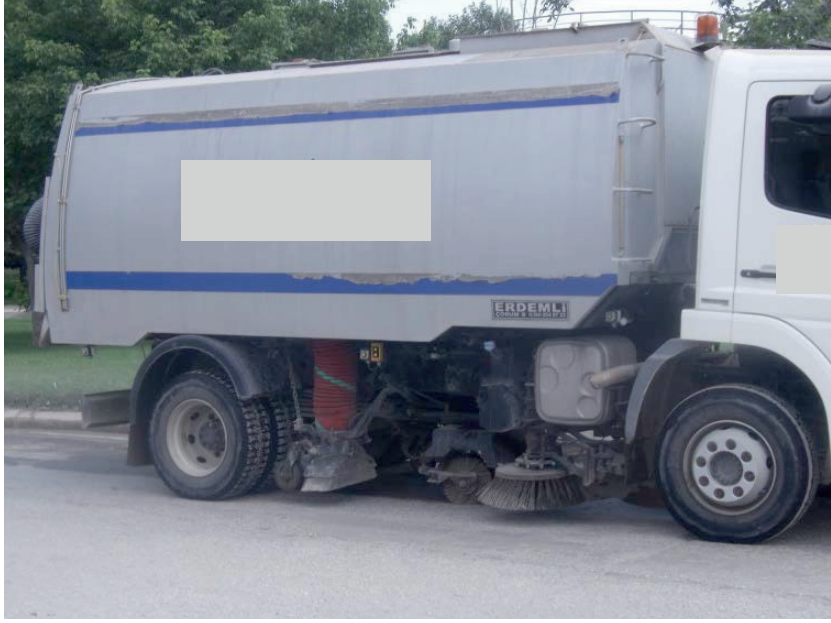
Resim 9. Araç geçişlerinin olduğu yollarda biriken tozu vakum yaparak ve filtreleyerek kendi deposuna çeken süpürge aracı
