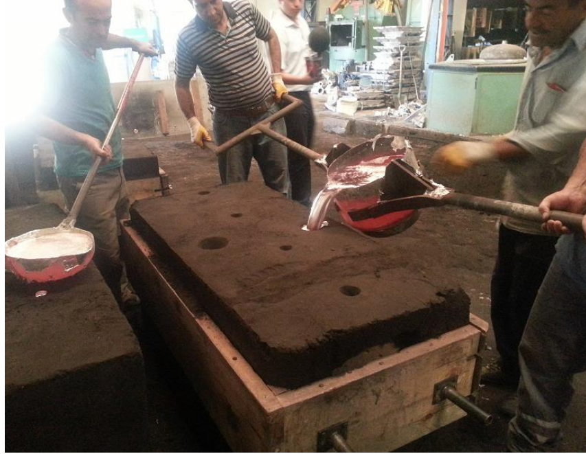
Şekil 7. İşletme 1 döküm aşaması
