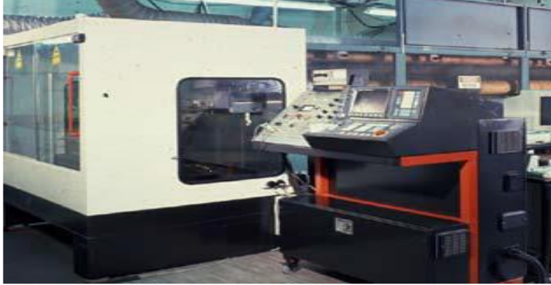
Şekil 5.1: Görüş panelleri ile optik radyasyonun filtrelenmesi
