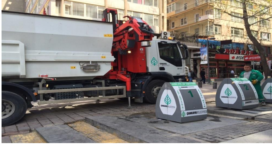
Şekil 25: Daldırmalı çöp konteyneri sistemi-2 (Çankaya Belediyesi)
