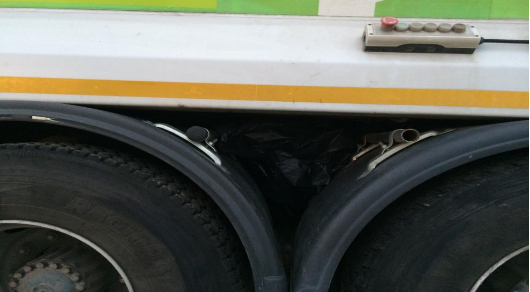
Şekil 14. Çöp aracında yangına sebebiyet verebilecek malzemeler
