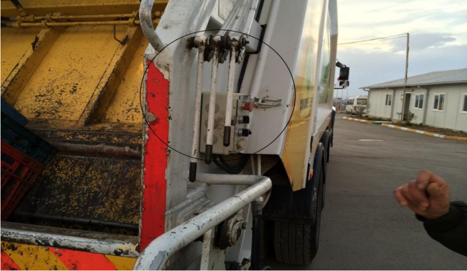
Şekil 12. Çöp aracındaki sıkıştırma mekanizması kumanda kolları
