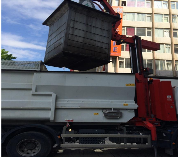
Şekil 26: Daldırmalı çöp konteyneri sistemi-3 (Çankaya Belediyesi)
