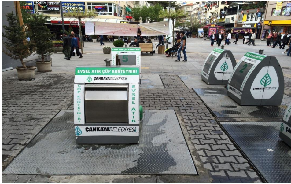
Şekil 24: Daldırmalı çöp konteyneri sistemi-1 (Çankaya Belediyesi)
