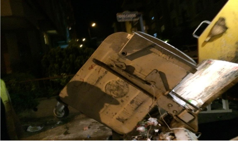
Şekil 18. Çöp boşaltım esnasında konteyner kapağının açılmaması
