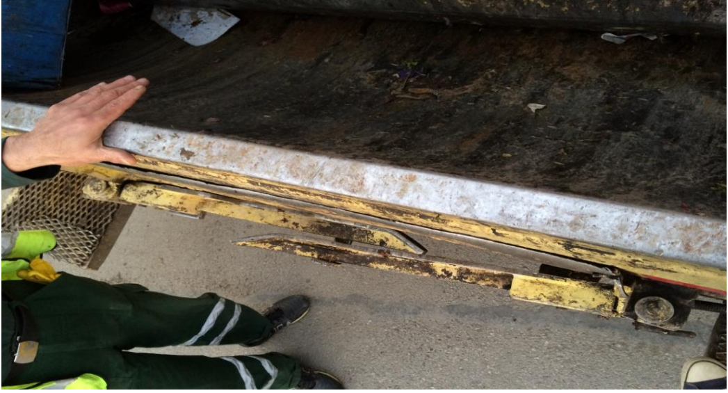
Şekil 13. Çöp aracındaki sıkıştırma mekanizmasında güvensiz davranış örneği
