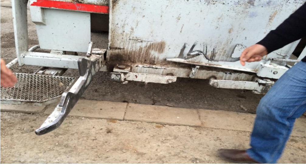
Şekil 15. Çöp aracındaki konteyner tutma sisteminin açık hali
