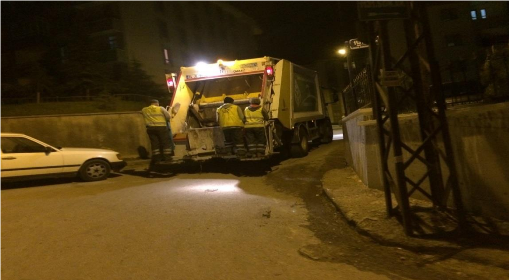
Şekil 16. Hareket halindeyken çöp aracının arkasında duran çalışanlar
