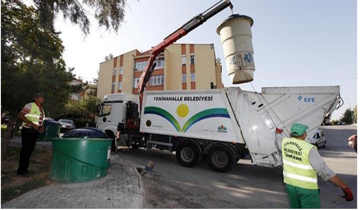
Şekil 27: Daldırılmalı çöp konteyneri sistemi (Yenimahalle Belediyesi)
