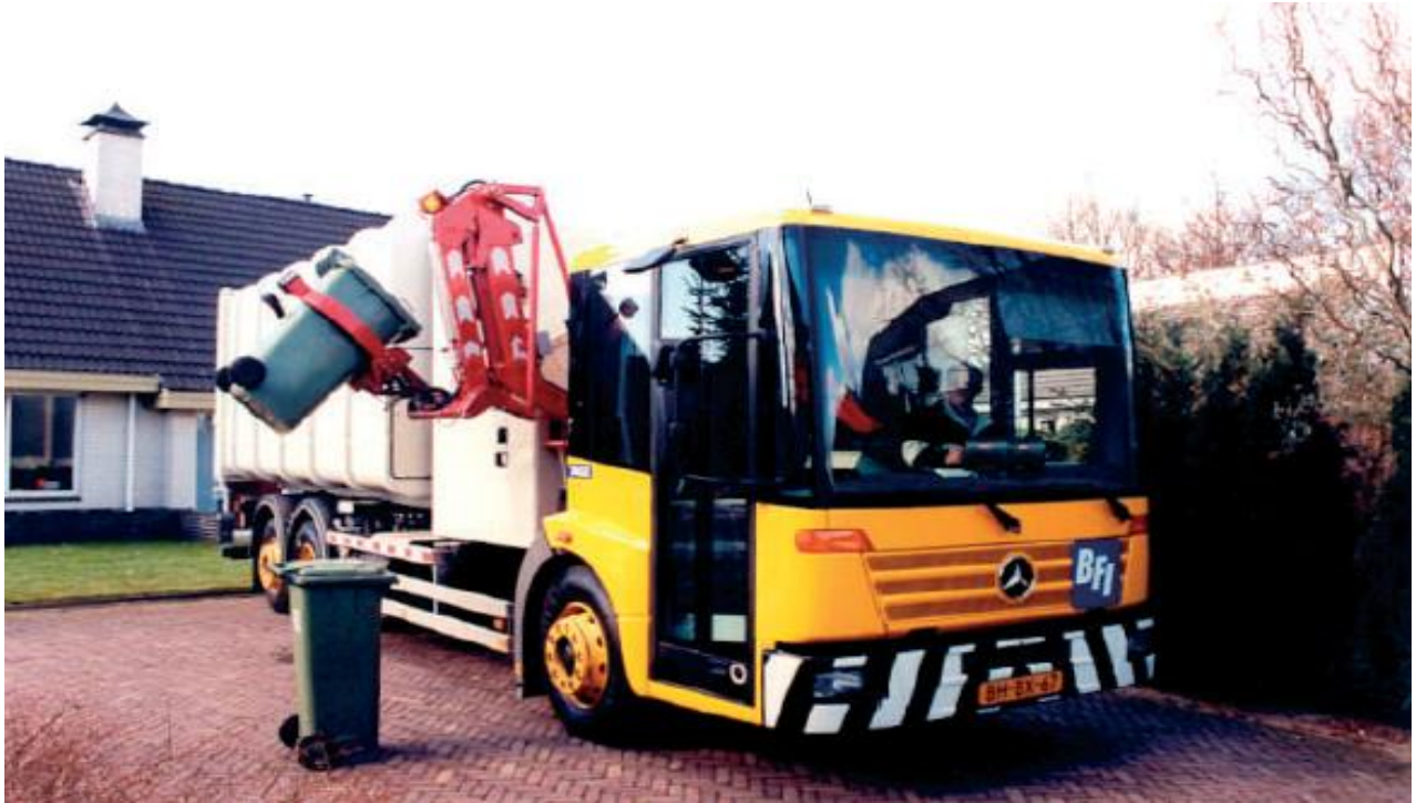
Şekil 23. Otomatik çöp boşaltma sistemine sahip bir çöp kamyonuna örnek
