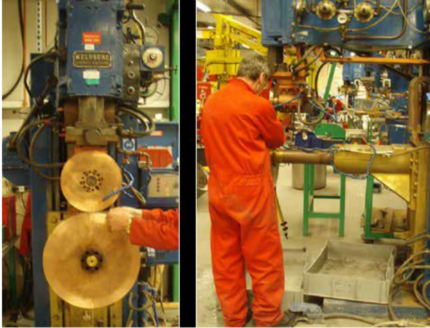
Şekil 7.3. Dikiş kaynağın önden ve yandan görünümü
