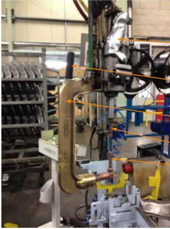
Şekil 6.16. Fabrikadaki 400 mm "C tipi" tabanca. Kelepçe, resmin sağ üst köşesinde görülen tabancanın üstündeki kollar (cıvalı krom bileşen) kullanılarak yerinde tutulmaktadır. Bu, operatörün kaynak sırasında kelepçeye göre konumu hakkında bir göstergedir
