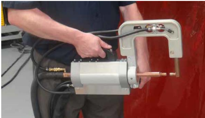
Şekil 6.4. Atölyede kullanılan 160 mm kol takılı “C-tipi” kaynak tabancası. Tabancanın ana gövdesi (çalışanın elinin altındaki kısım), bir elektrotu diğerine zorlayan bir piston içerir. Kaynak akımı, kontrol ünitesinden resmin solundaki kablolarla iletilmektedir.
