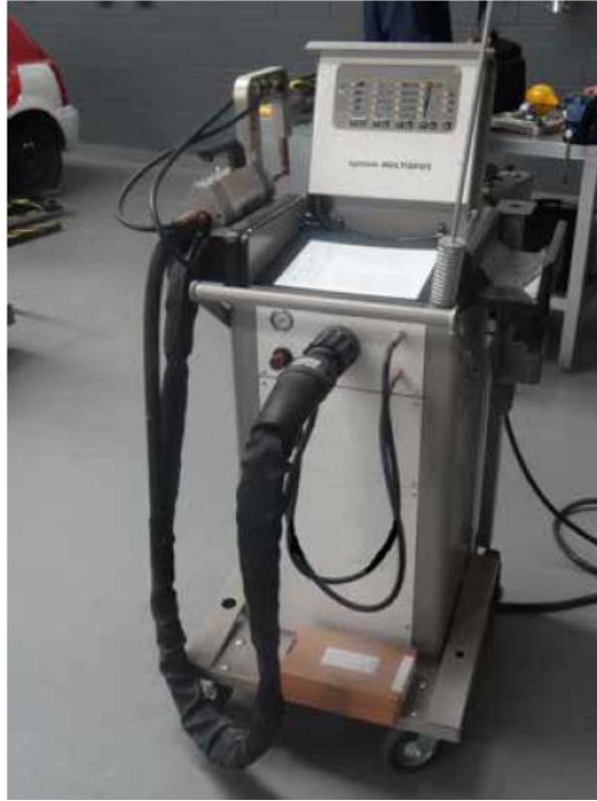
Şekil 6.2. Tipik bir karoser tamir atölyesi el tipi punta kaynağı. Sistem tekerlekli kontrol ünitesi ile hareketlidir. Elektrik ve soğutma suyu besleme kabloları ünitenin önünden ayrılır ve tutucuda kontrol panelinin solunda bulunan kaynak tabancasının arkasına beslenir
