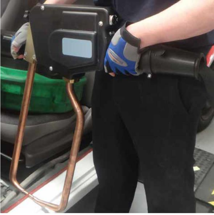
Şekil 6.5. Atölyede kullanılan 550 mm' lik elektrotlar takılı "X tipi" kaynak tabancası. İki elektrot, kaynak akımını besleyen transformatörü de içeren tabancanın ana gövdesinde (çalışanın elleri arasındaki kısım) bir piston tarafından kısıkaç hareketiyle zorlanmaktadır.
