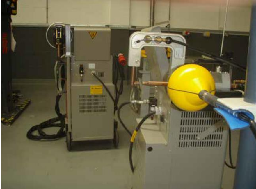
Şekil 6.7. Tamir atölyesindeki “C tipi” tabanca ve 160 mm kol takılı punta kaynak makinesinin etrafında alınan ölçümler. Arka planda “X tipi” tabanca kaynak makinesi de bulunmaktadır
