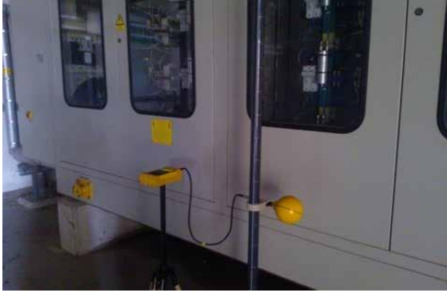
Şekil 3.6. Tristör doğrultucu yakınında yapılan ölçümler
