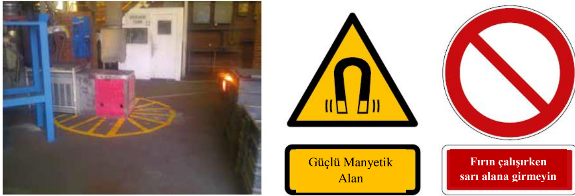
Şekil 8.7. Eylem değerlerinin aşılabileceği alanı gösteren boyalı zemin ve ilgili uyarı ve yasak notları
