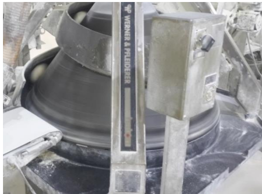
Resim 4.1. E işyerinde koruyucusu olmayan hamur yuvarlama makinesi
