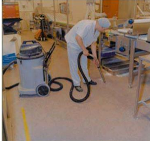
Resim 2.6. Un tozunun vakumlu sistem ile temizlenmesi [20]
