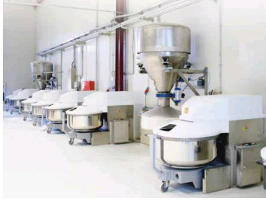
Resim 2.1. Koruyucu donanımı kapatılmış hamur yoğurma makineleri
