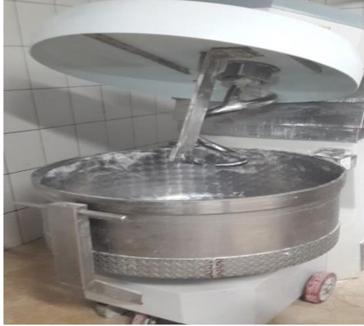
Resim 4.3. D işyerinde koruyucu kapatılmadan çalıştırılmayan hamur yoğurma makinesi
