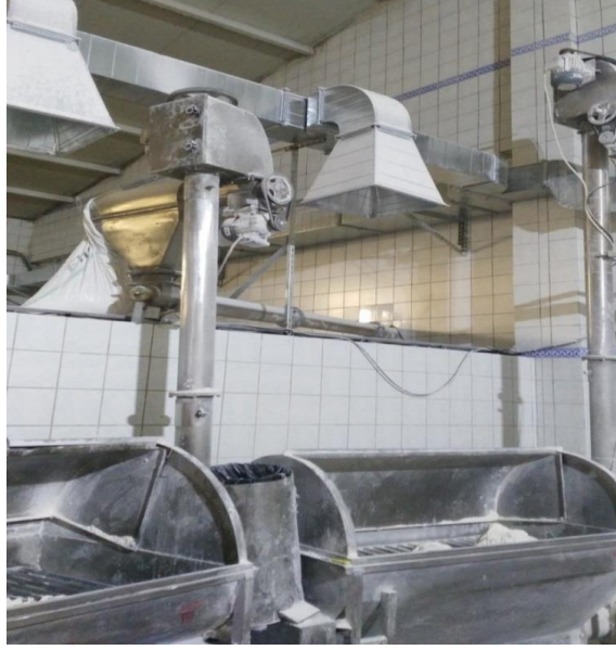
Resim 4.9. C işyerinde lokal aspirasyon sistemi bulunan un elekleri
