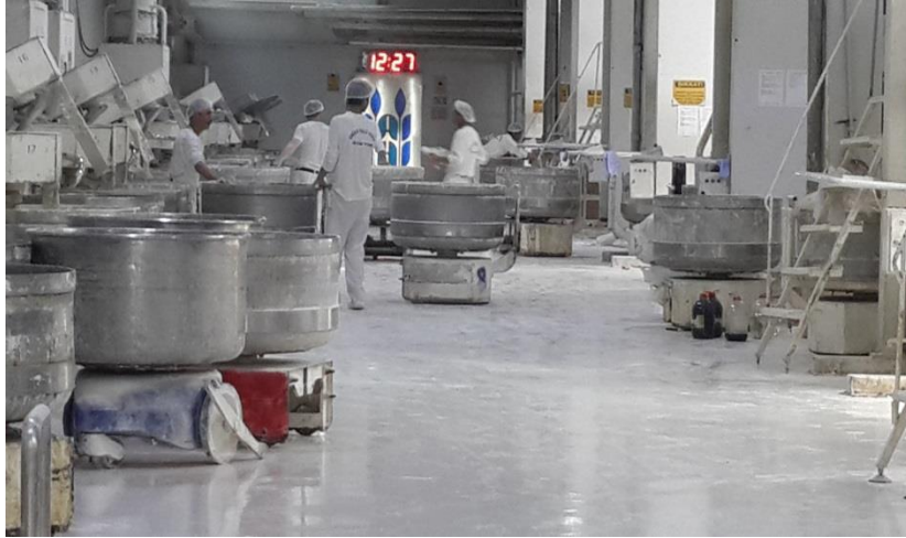
Resim 4.17. A işyerinde 600 kg ağırlığındaki hamur kazanlarının itilmesi-çekilmesi
