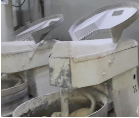
Resim 4.2. A işyerinde koruyucu kapağı açık vaziyette çalışan hamur yoğurma makinesi
