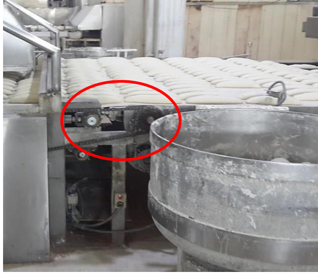
Resim 4.4. A işyerinde zincir kısmı açıkta bulunan bir konveyör bant
