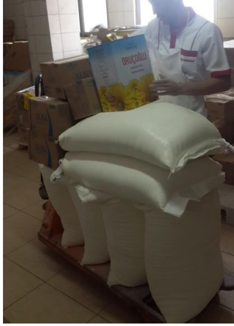
Resim 4.16. B işyerinde aşırı yükleme yapılmış bir transpalet
