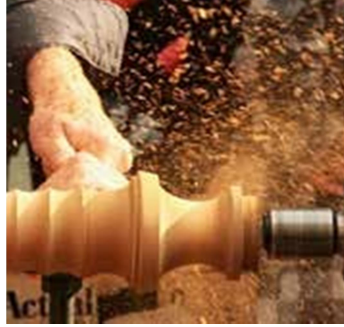
Resim 4.2. Ahşap işleme bölümünde toza maruziyet ve talaş sıçraması riski
