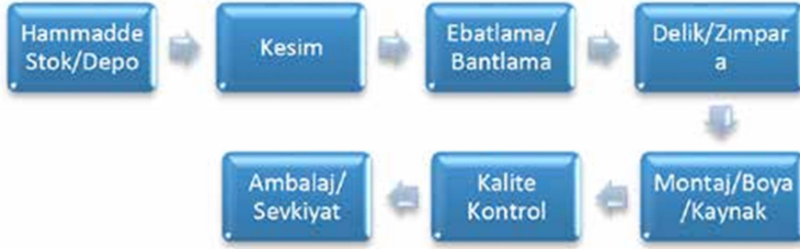
Şekil 2.1. Mobilya İmalatı Akış Şeması
