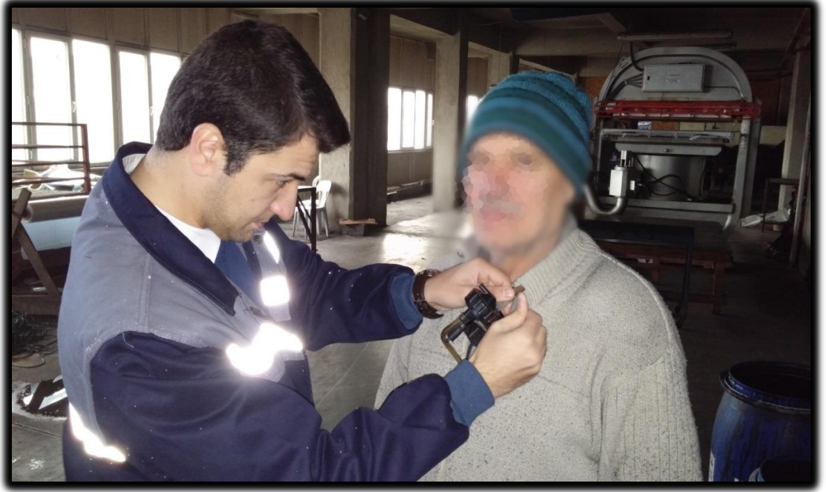
Resim 3.4. Solunum Bölgesine Denk Gelecek Şekilde Hava Örnekleme Pompasının Yerleştirilmesi
