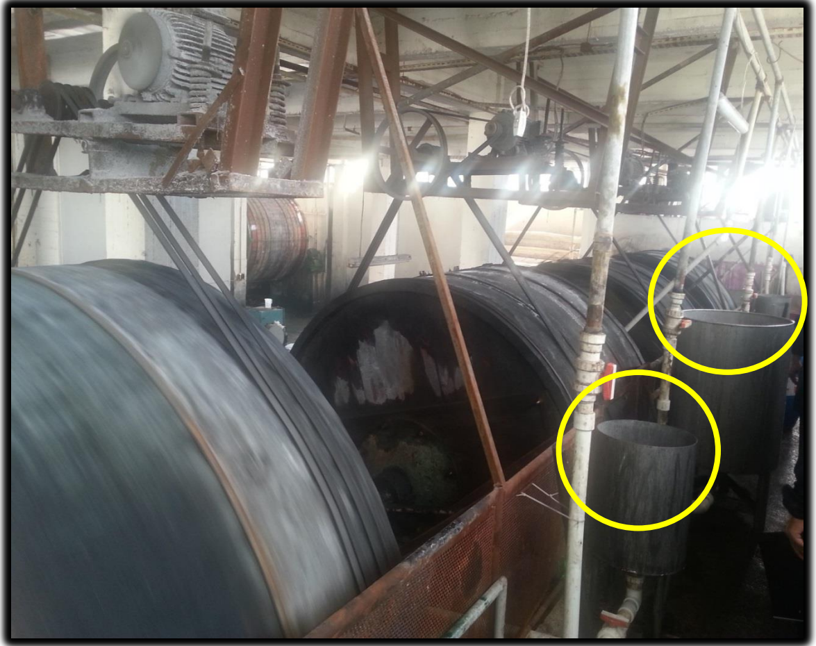
Resim 4.7. Ağız Açık Kaplarda Asit Depolama
