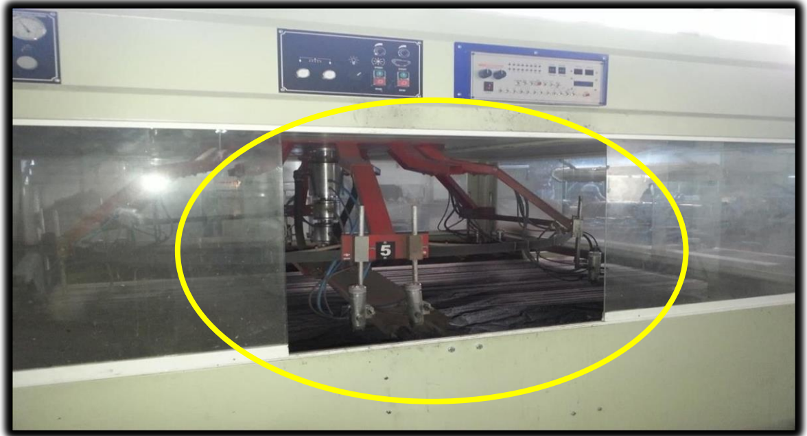
Resim 4.2. Püskürtme Boya İşleminde Açık Bırakılan Cam Koruma Kapakları
