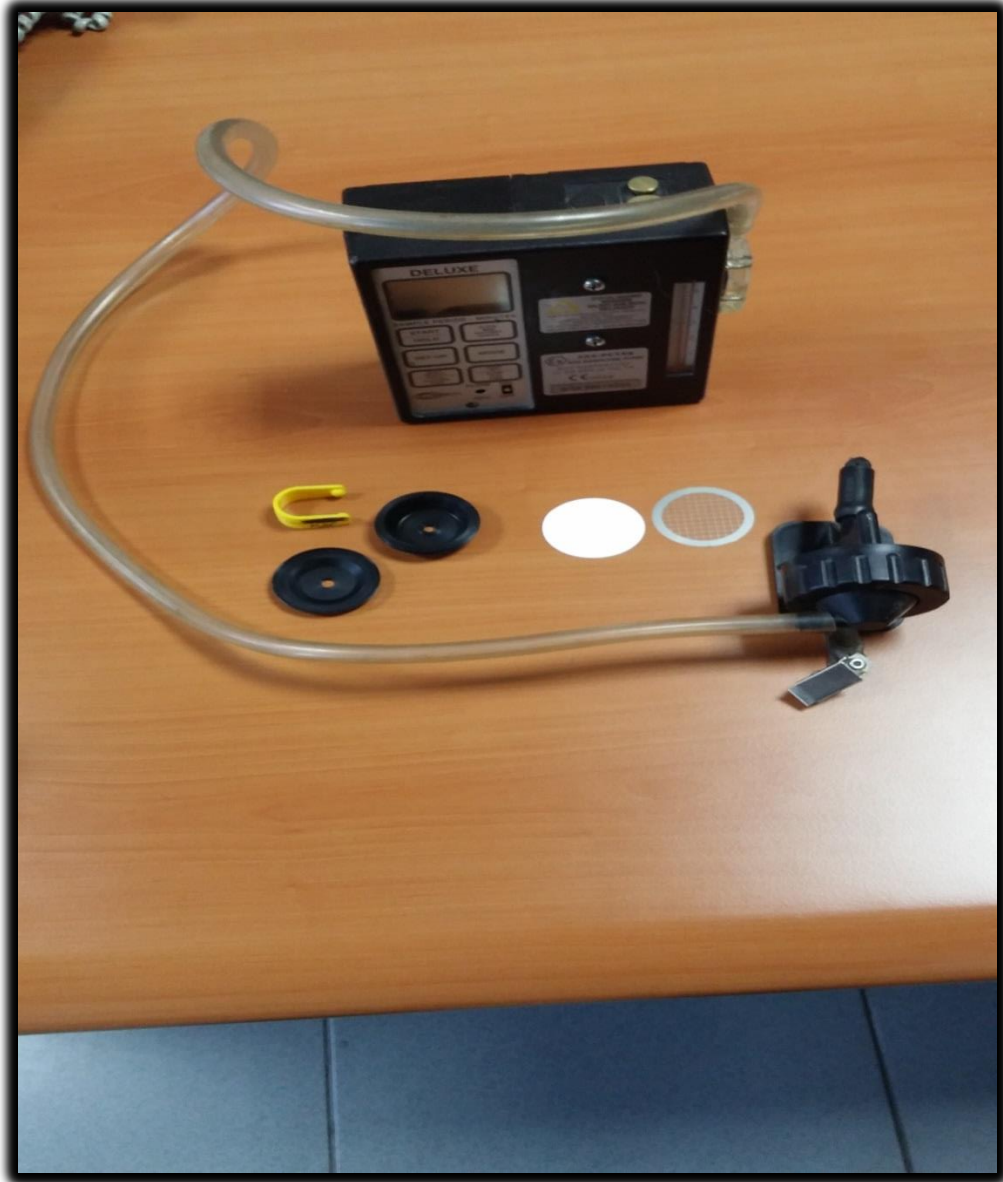
Resim 3.2. Hava Örnekleme Pompa Sistemi Örneđi
