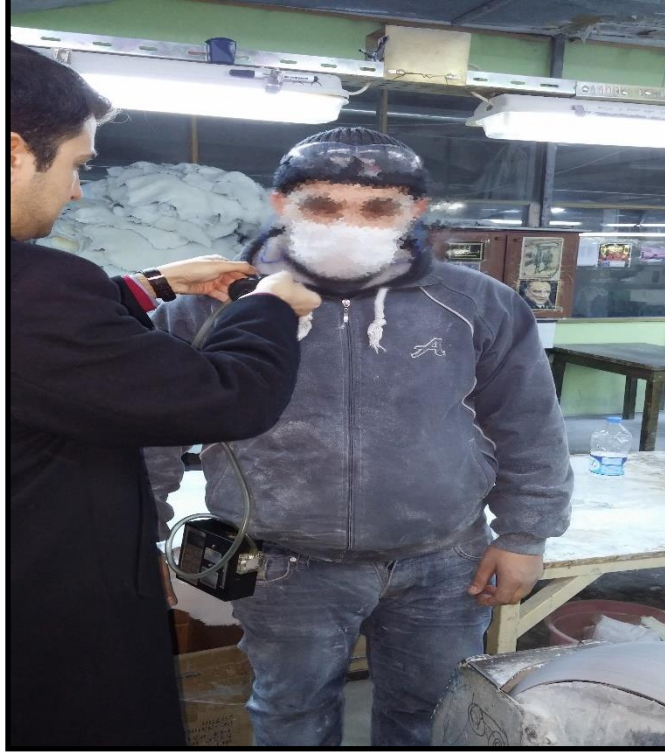
Pompa sistemi ile kişisel maruziyet ölçümü
