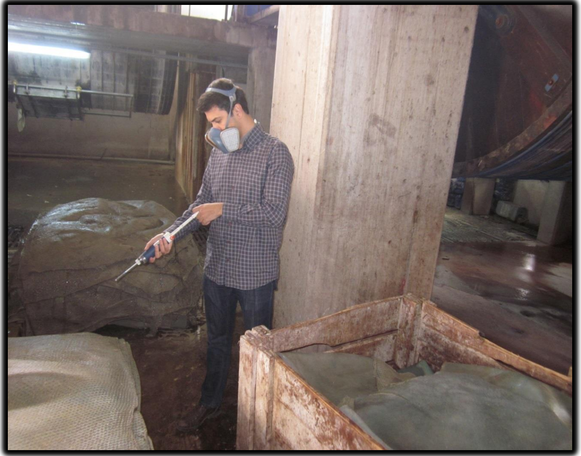
Resim 3.1. Dedektör Tüp İle Anlık Gaz Ölçümü
