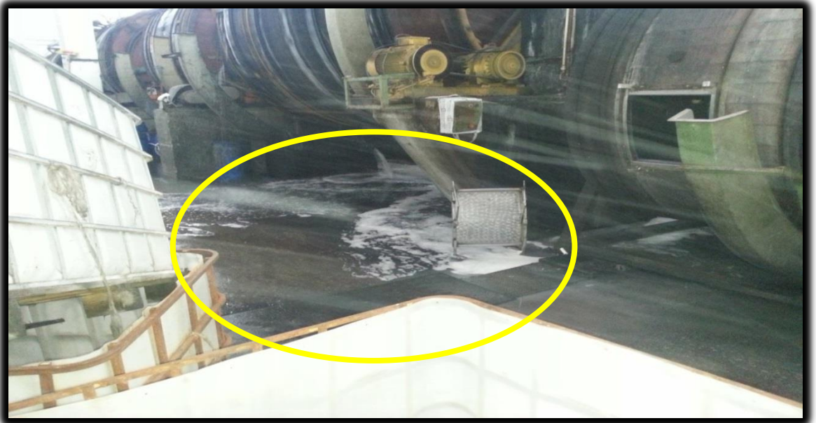
Resim 4.6. Mikserlerde Yapılan İşlemler İçin Yetersiz Kalan Gider
