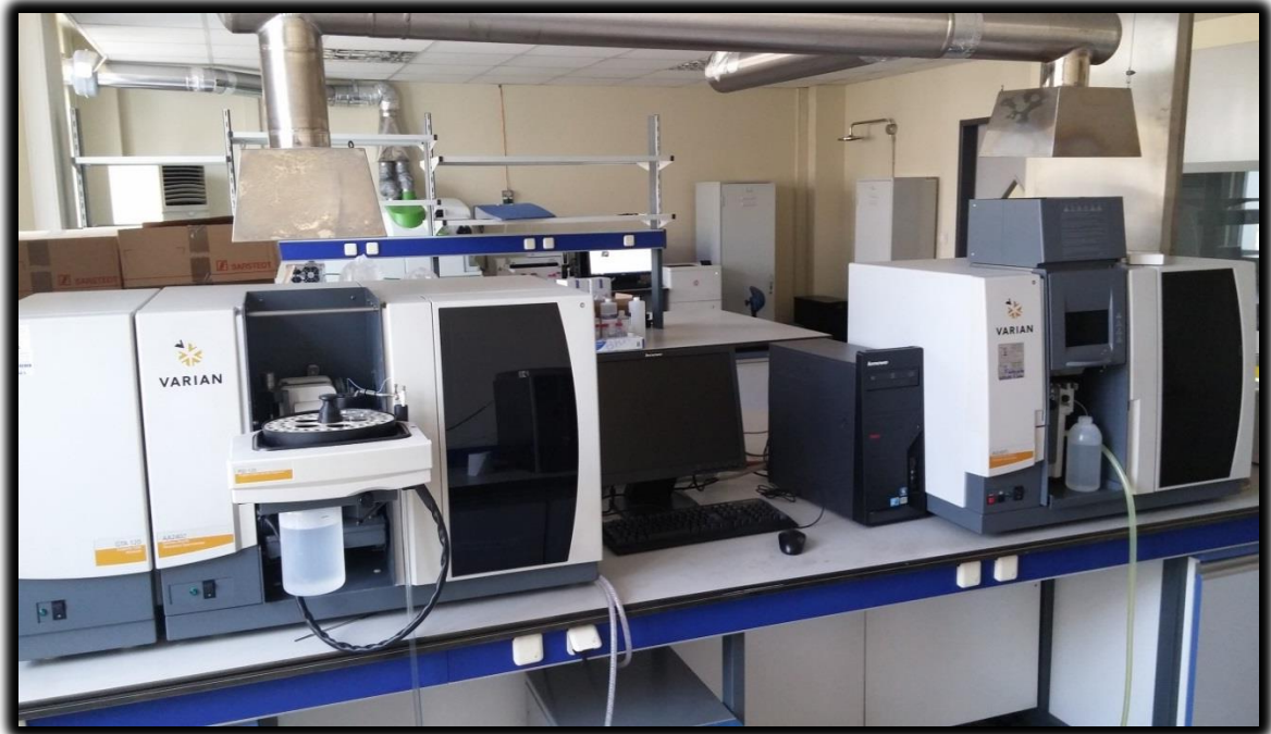
Resim 3.7. Atomik Absorbsiyon Spektrofotometresi Cihazı
