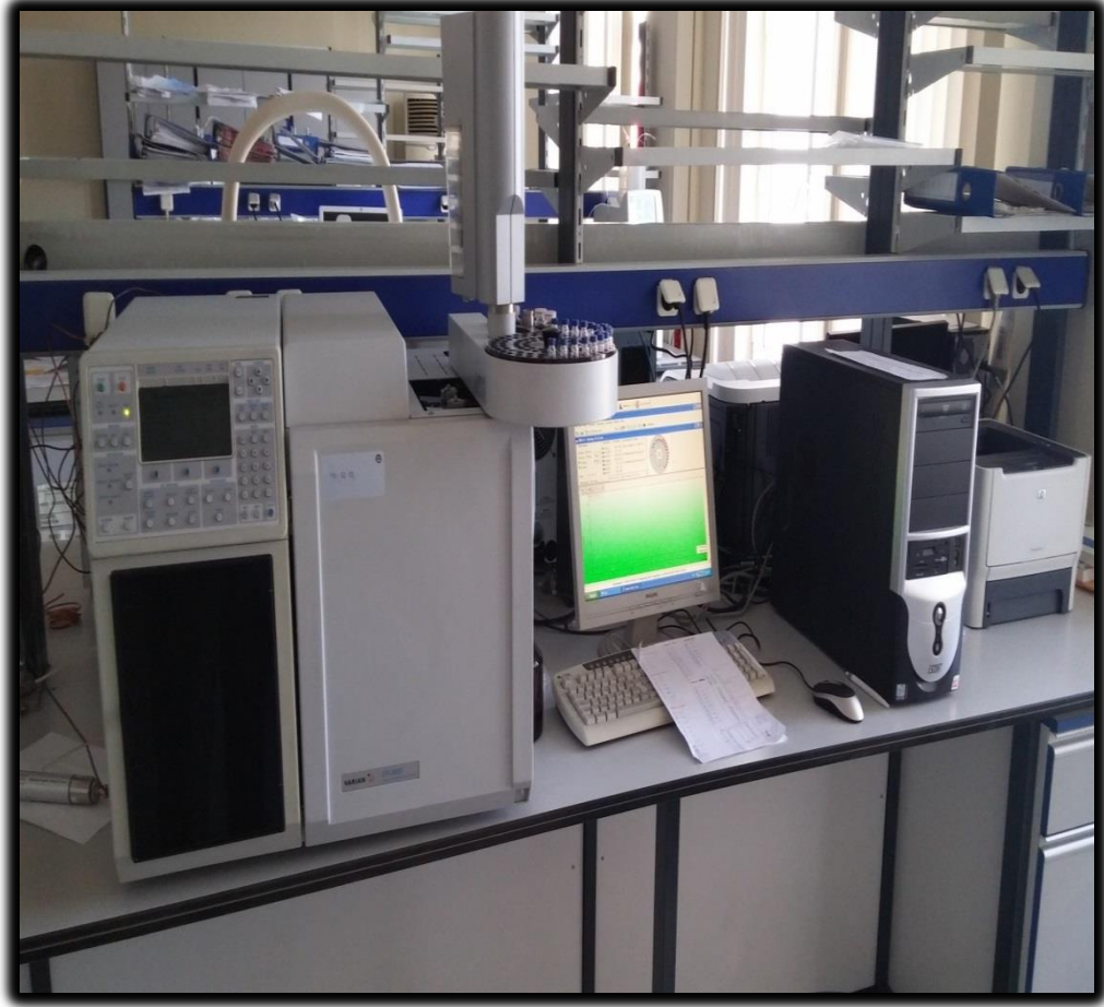
Resim 3.6. Gaz Kromatografi Cihazı
