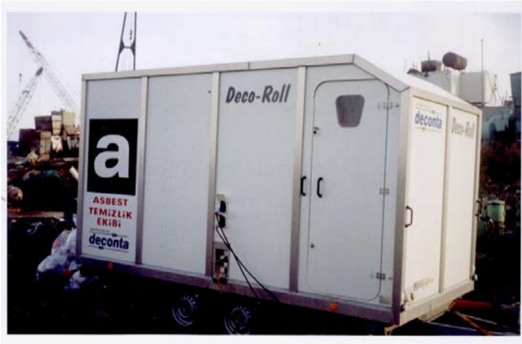
Asbest ekibini asbest toz ve liflerinden arındırma ünitesi
