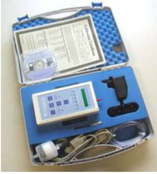
Lazerli asbest lif ölçüm cihazı
