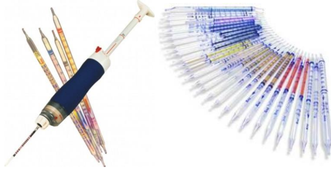
Resim 3.1. Anlık gaz pompası ve detektörü [16]
