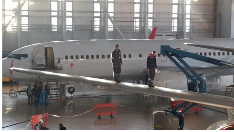
Şekil 14. Kanatta tedbir alınmadan çalışılması
