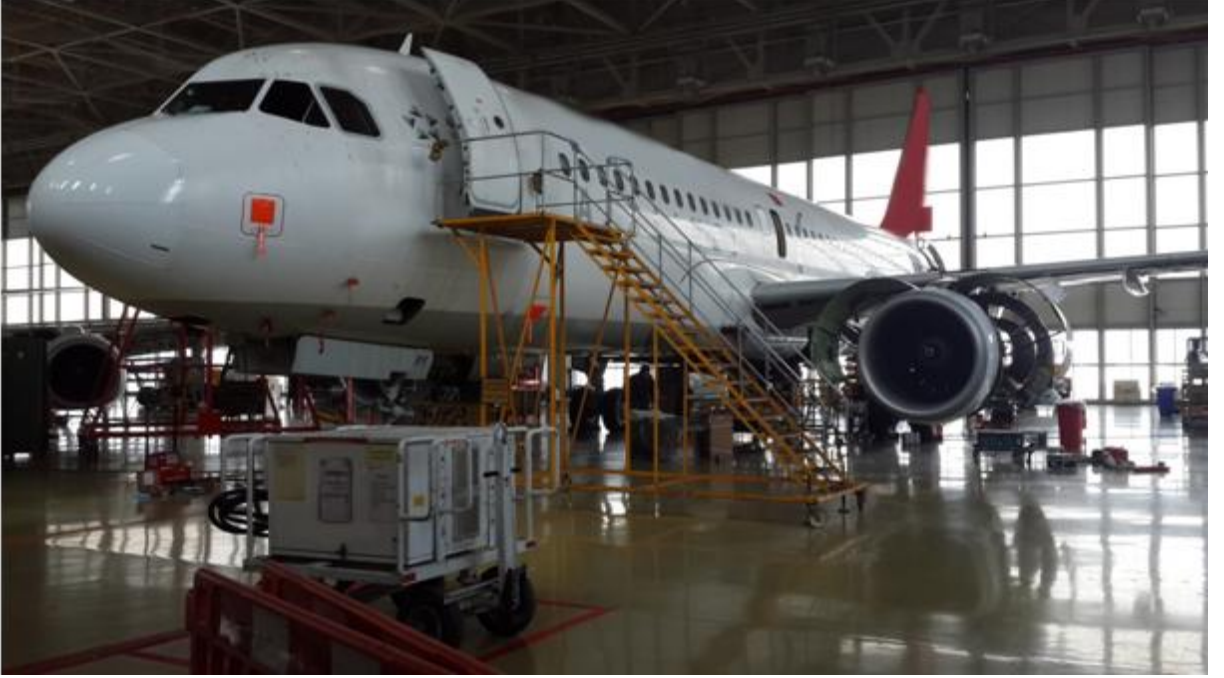
Şekil 5. Yüksekte çalışmada merdiven kullanımı
