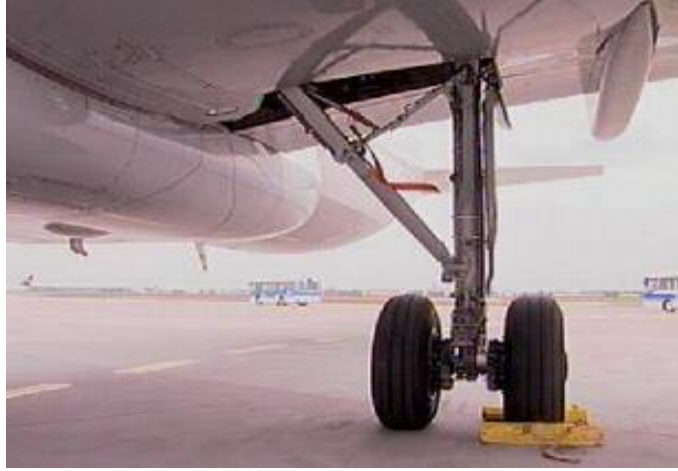
Şekil 4. Lastikleri takozlanmış ve iniş takımı pimleri takılmış park halindeki uçak [17]
