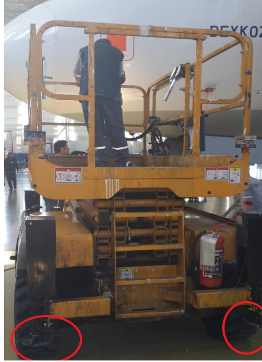
Şekil 16. Yükseltilebilen seyyar iş platformunun ayaklarının sabitlenmemesi
