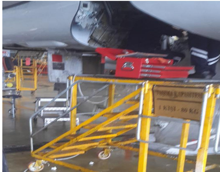
Şekil 13. Merdiven platformunda kapasitesinden fazla kişinin olması
