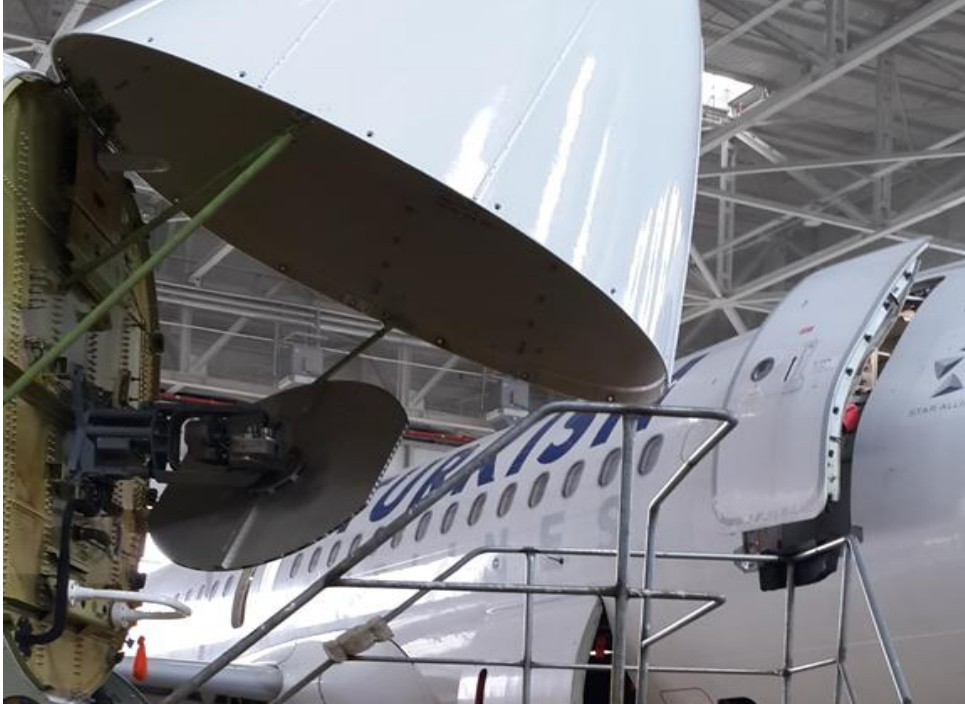
Şekil 25. Sigortaları çekilerek bakıma alınmış radar
