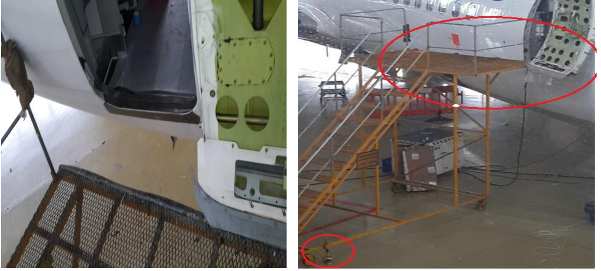
Şekil 10. Merdivenin uçak kapısına uygun konumlandırılmaması
