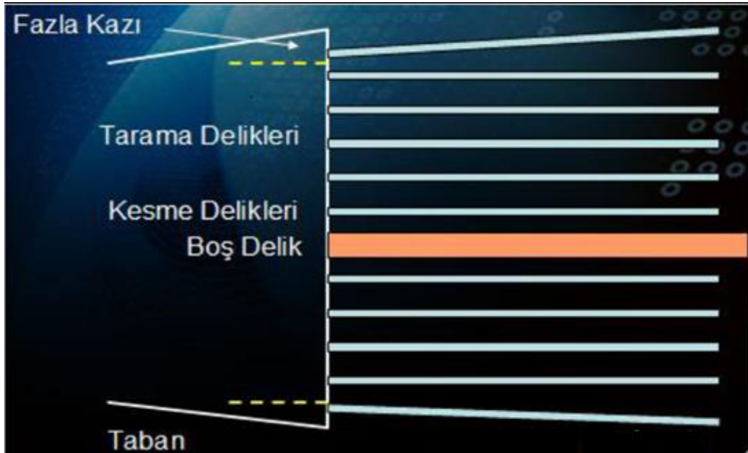
Şekil 2.3. Galeri patlatmalarında paralel kesme yöntemi [8]
