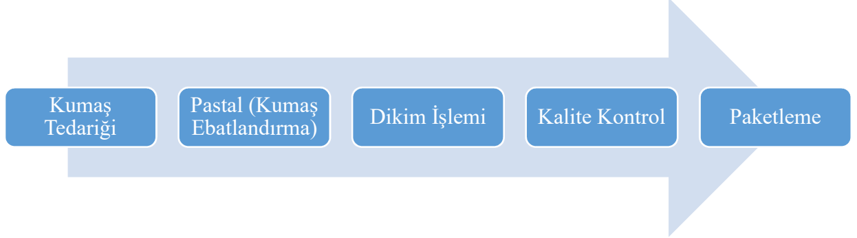
Şekil I-3 Örme Giyim Eşyası Üretim Akış Şeması
