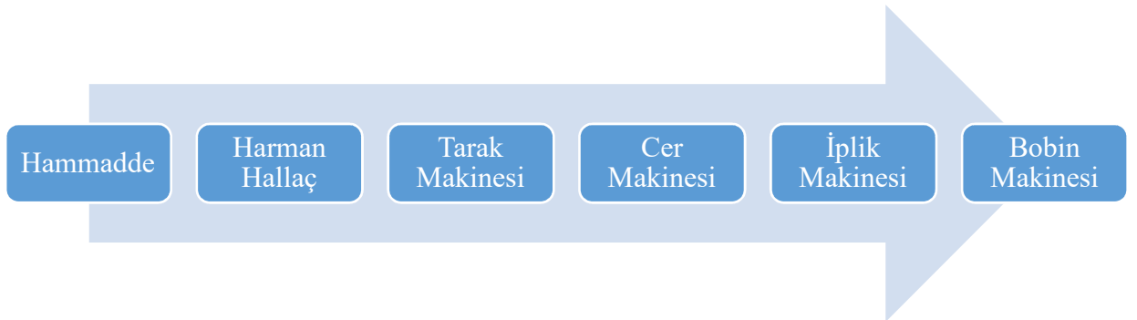
Şekil I-1 İplik Üretim Akış Şeması
