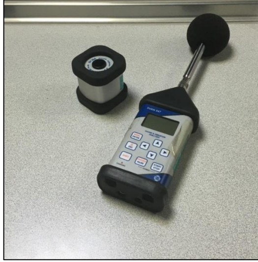
Resim 3.1. Gürültü - titreşim ölçer ve kalibratörü
