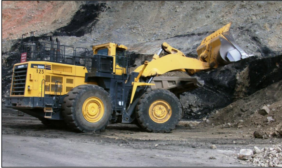
Resim 2.2. Lastik tekerlekli yükleyici (loder)
