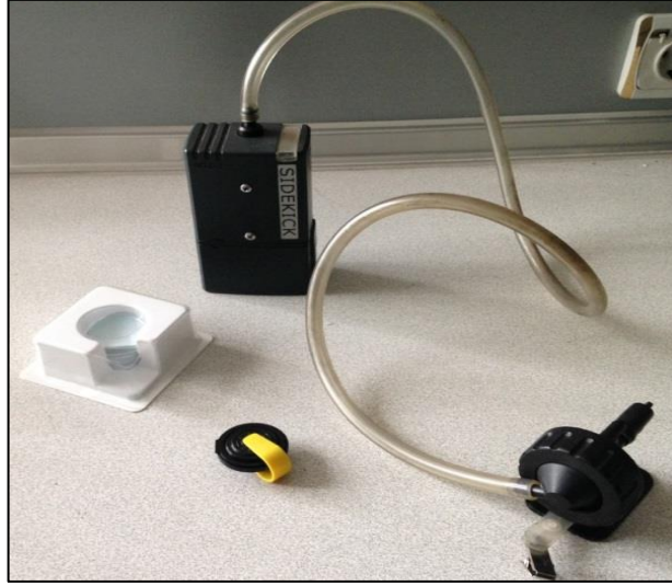
Resim 3.3. Kişisel hava örnekleme pompası, siklon başlık, PVC filtre ve filtre kaseti
