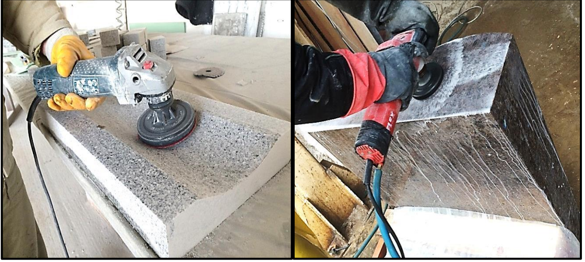
Resim 2.10. Spiral taşlama aleti ile el işçiliği uygulaması
