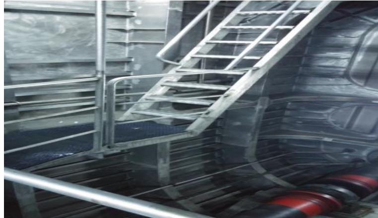
Resim 2.22. Çalışan Milin Üzerinde Dik Bir Merdiven
