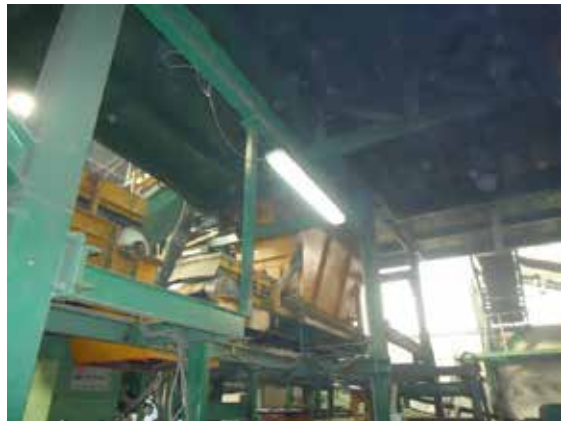
Makine içlerindeki aydınlatmalardan hasarlı olanların düzeltilmiştir. 24V olarak değiştirilmiş yada etanj hale getirilmiştir.
