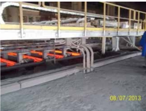
SDM bölümünde açıkta kalan platform altına müdahale korkuluklarla engellenmiştir.
