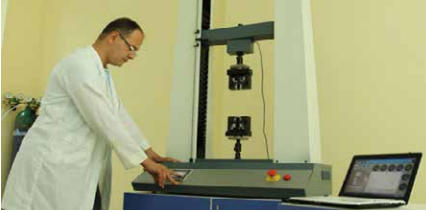
Resim-16 Üretilen Çubuk Demirlerin Çekme Testlerinin Yapıldığı Cihaz
