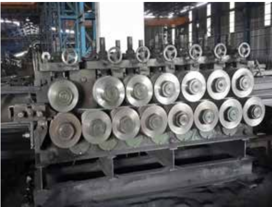
Doğrultma makinaları koruyucu içine alınmıştır.
