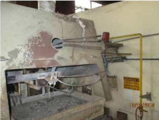
İşyerinde kalay döküm fırınının yan kapakları açıktadır,kapatılmıştır.
