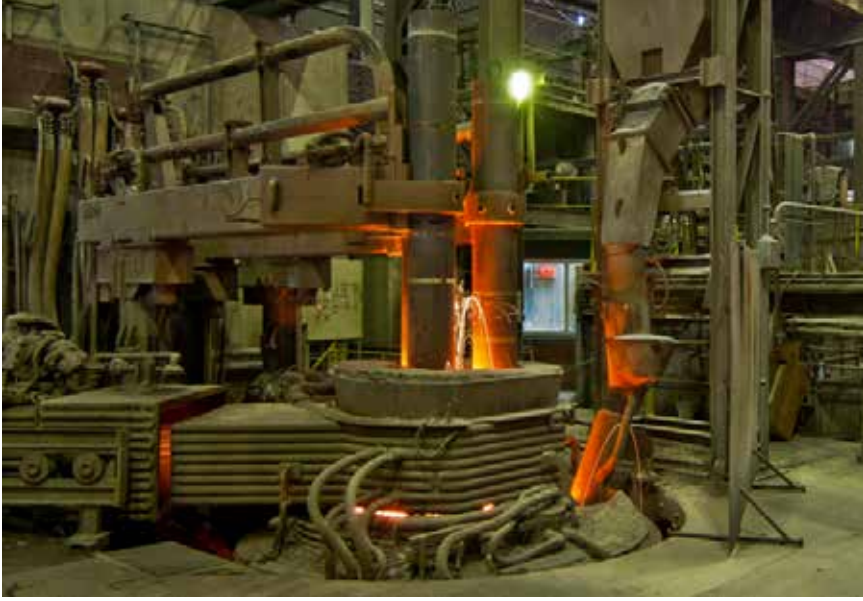
Resim-6 Sıvı Çeliğin, Sürekli Döküm Makinası İçin Pota Ocağında Gerekli Sıcaklığa Kadar Isıtılması
