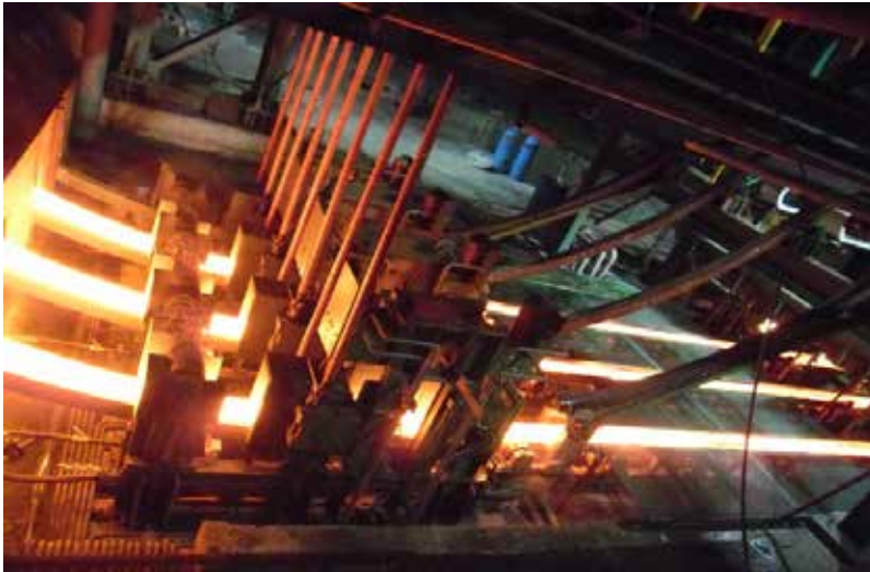
Resim-8 Bakır Kalıplardan Katılaştırılıp Kontrollü Olarak Soğutulmuş Kütük Haline Getirilen Çelik
