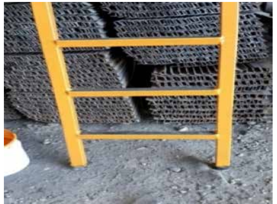
Seyyar merdivenler kaymayı engelleyecek şekilde kauçuk tabanlı ve kancalı hale getirilmiştir.
