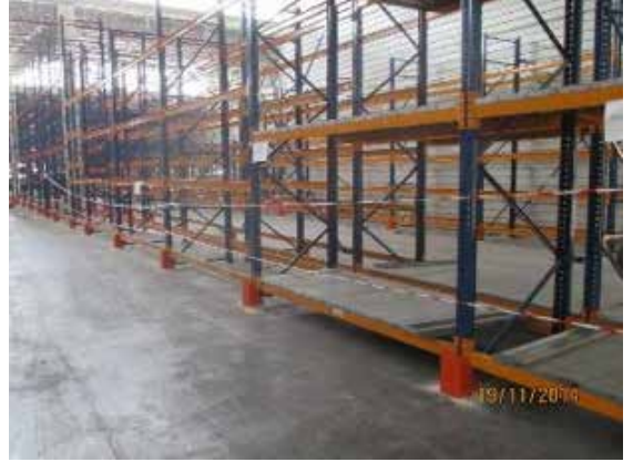
Lojistik bölümünde bulunan raflara forklift çarpmasına karşı tertibat yapılmıştır.
