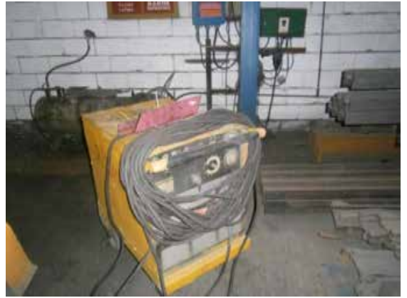
Kaynak makinesinin tutamağı elektrik kaçaklarına karşı yalıtkan malzeme ile kaplanmıştır.
