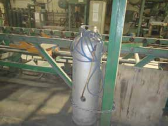
LPG tüpünde şalomaya geri tepme ventili takılmıştır.
