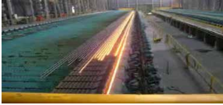
Resim-14 Haddelenen Çeliğin Çubuk Haline Getirilmesi
