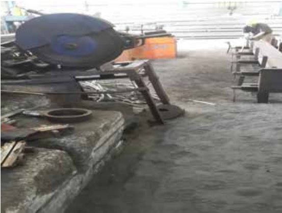
Daire testerelerin koruyucuları iyileştirilmiştir.
