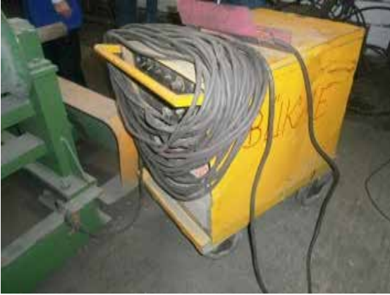
Kaynak makinesinin tutamağı elektrik kaçaklarına karşı yalıtkan malzeme ile kaplanmıştır.
