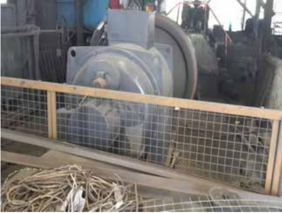
Döner ekipmanlar (volon) için koruyucu yapılmıştır.
