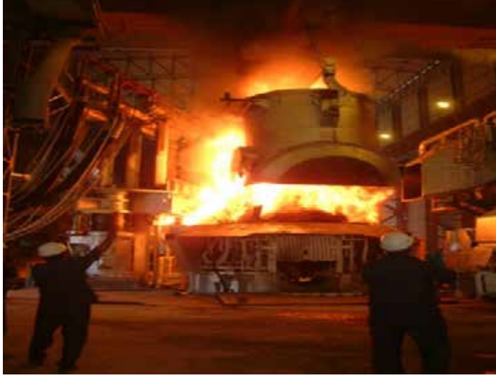
Resim-3 Elektrik Ark Ocağı-Şarj İşlemi
