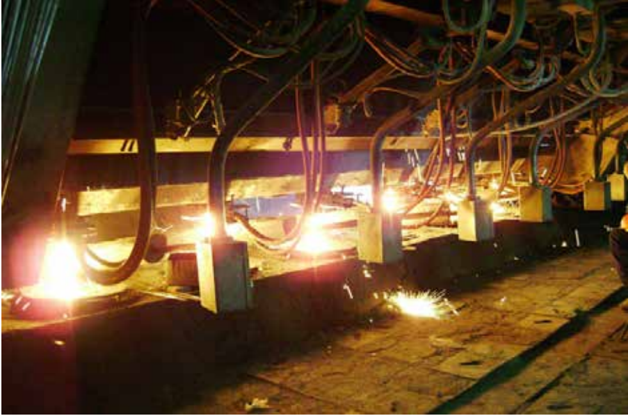
Resim-7 Sıvı Çeliğin Tandiştan Bakır Kalıplara Aktarılması
