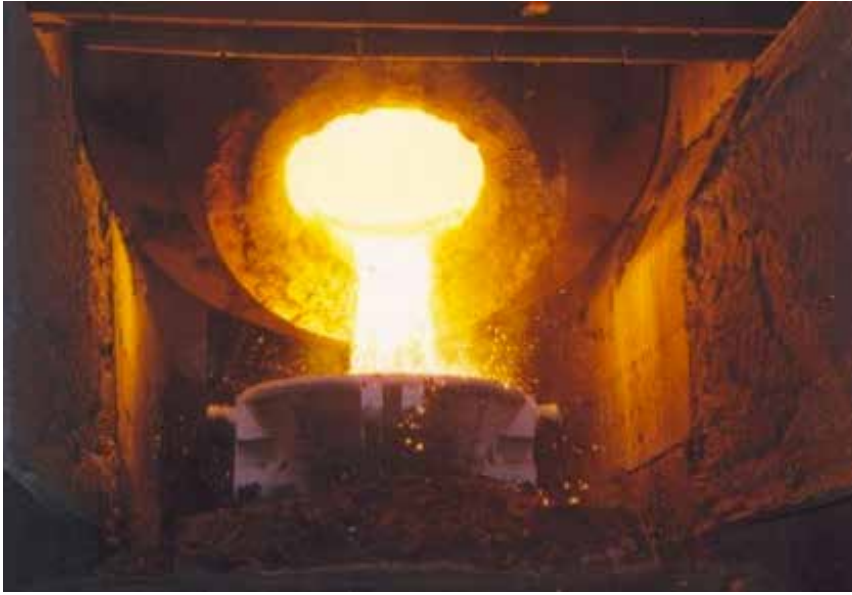
Resim-5 Şarj Edilerek Sıvı Hale Getirilen Çeliğin Potaya Aktarılması
