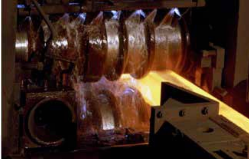
Resim-13 Haddelenen Çeliğin İçerisinden Geçerek Şekillendirildiği Değişik Kesitlerdeki Merdaneler
