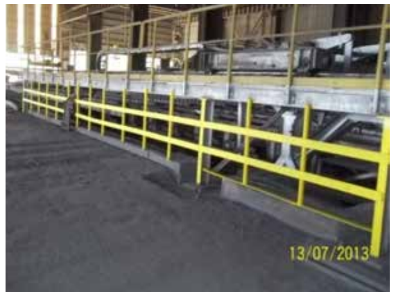
SDM bölümünde açıkta kalan platform altına müdahale korkuluklarla engellenmiştir.
