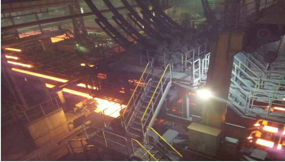
Resim-9 Kontrollü Olarak Soğutulmuş Kütük Haline Getirilen ve Belli Boylarda Kesilen Çelikler
