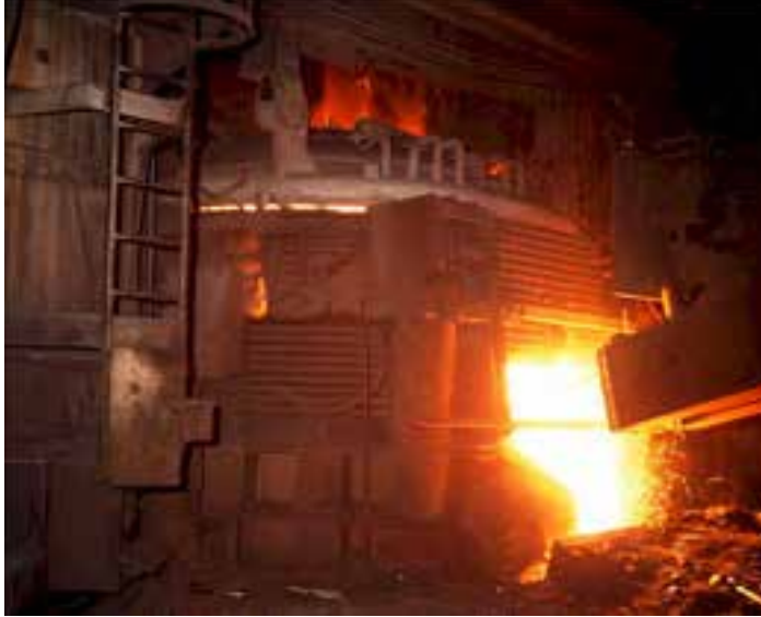
Resim-4 Elektrik Ark Ocağı - Robotik Oksijen-Karbon Lans Manüplatörü
