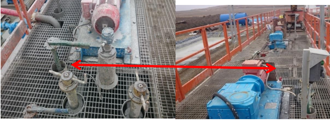
Resim 4.12. Çamur motorları ve çamur ölçümü için kullanılan delik
