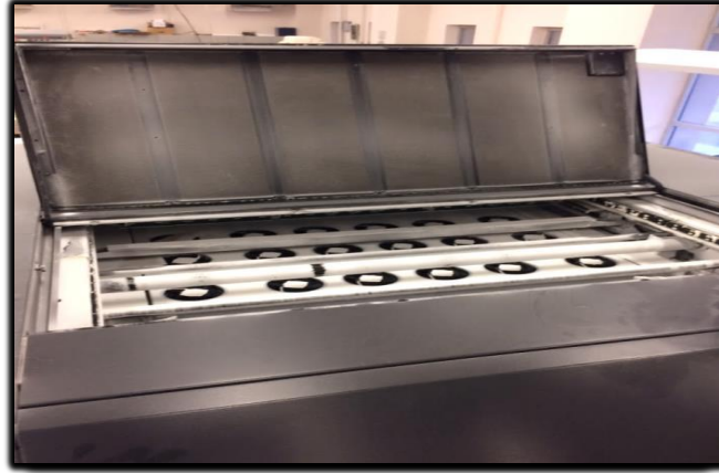
Resim 4.1. Baskı Merdanelerinde Biriken Kağıt Tozları
