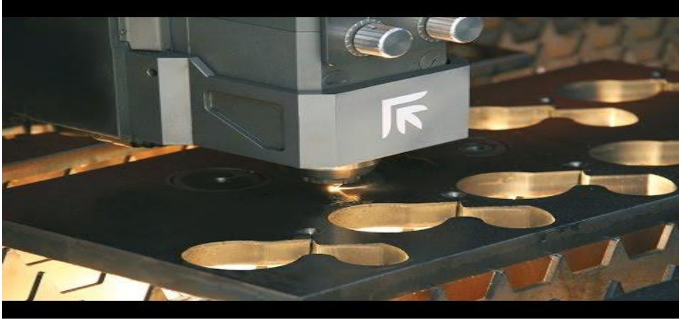
Video 1.1: Örnek lazer kesimi (güçlü lazerler, metal plakaları kolaylıkla kesebilmektedir).**
